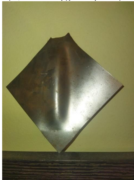
Εικόνα 25 Έλασμα μετά το μονοαξονικό εφελκυσμό
