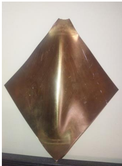
Εικόνα 31 Έλασμα μετά το μονοαξονικό εφελκυσμό
