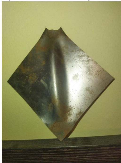
Εικόνα 29 Έλασμα μετά το μονοαξονικό εφελκυσμό
