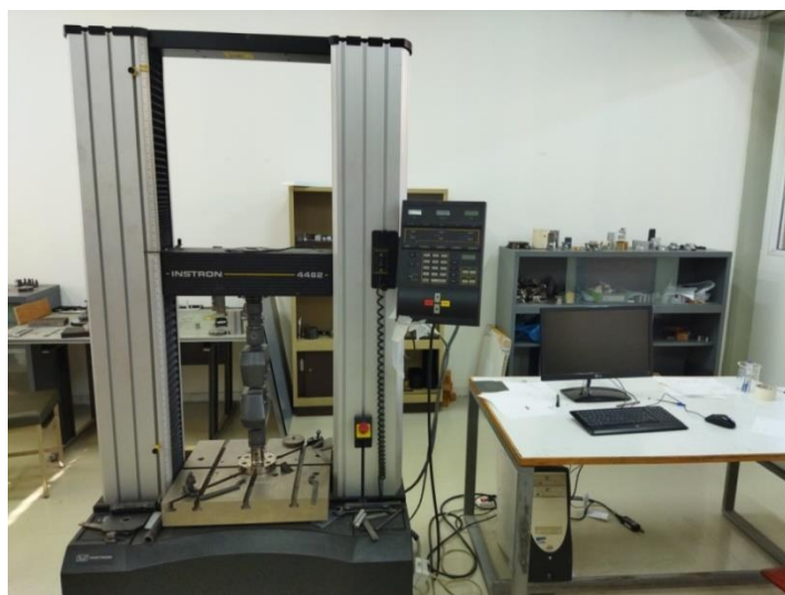
Εικόνα 15 Πειραματική διάταξη μηχανική πρέσα και ηλεκτρονικός υπολογιστής καταγραφής των δεδομένων
