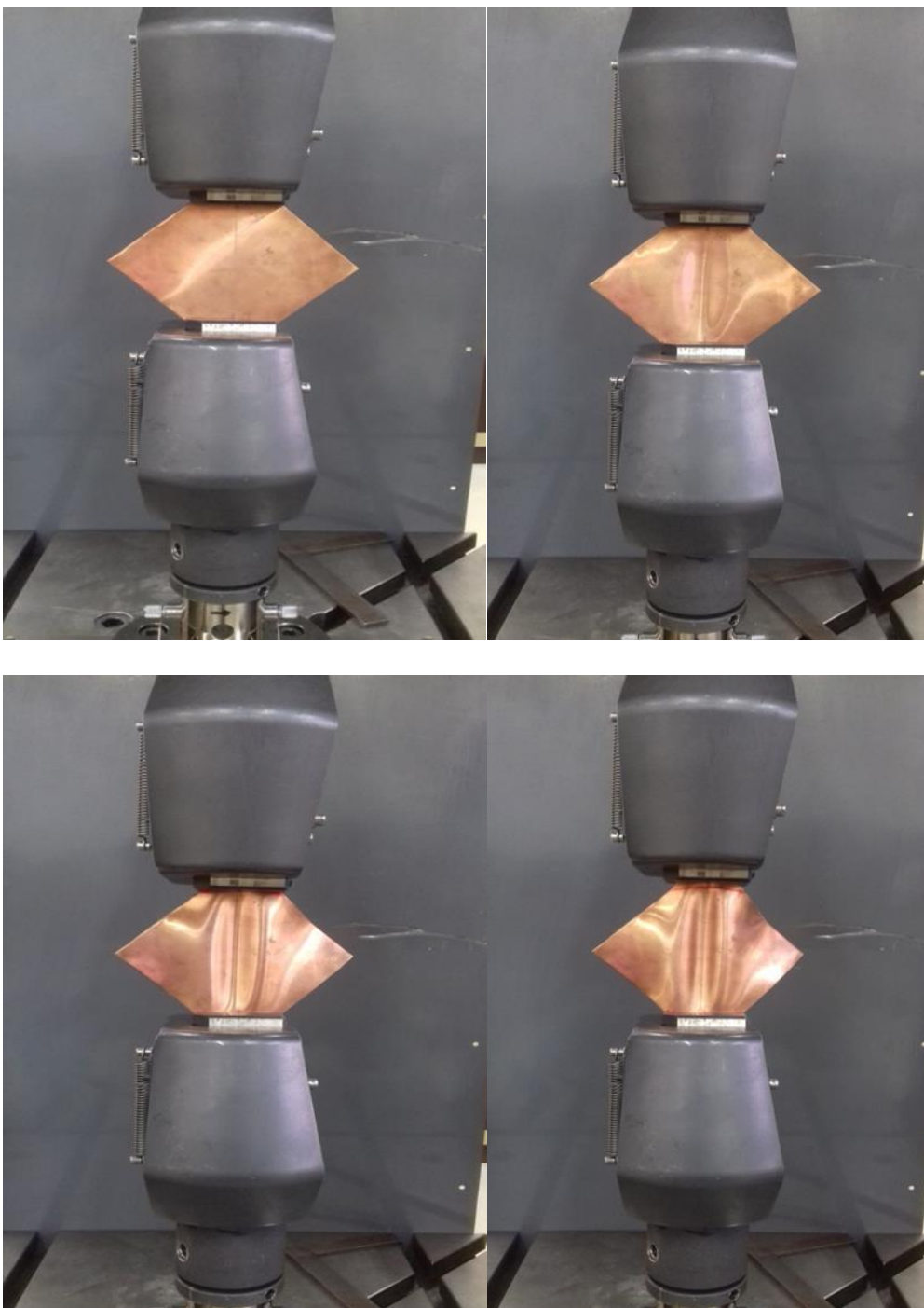
Εικόνα 20 Αρχικό, ενδιάμεσο και τελικό στάδιο διαδικασίας, , Διατομή 100·100, Πάχος 0.5mm
