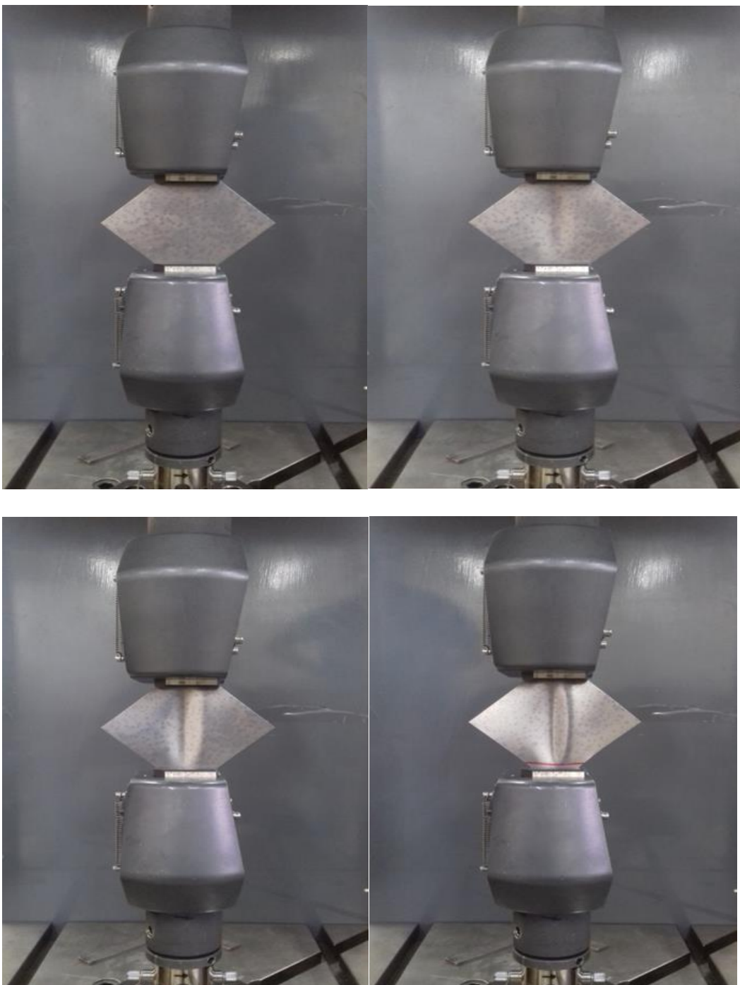
Εικόνα 24 Αρχικό, ενδιάμεσο και τελικό στάδιο διαδικασίας, Διατομή 100·100, Πάχος 0.5mm
