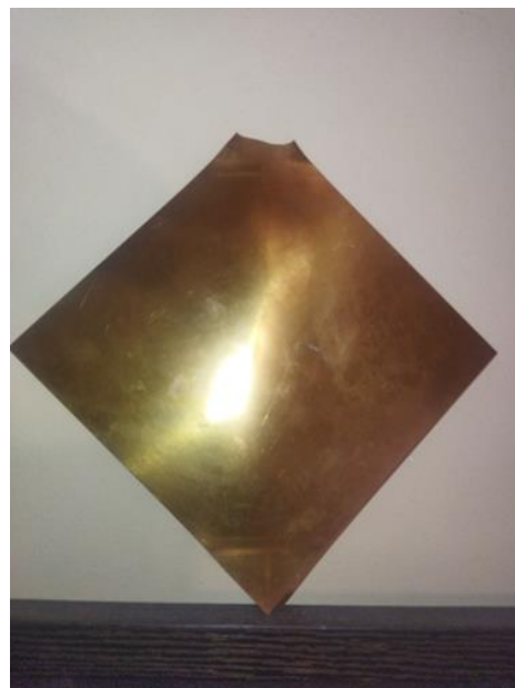
Εικόνα 33 Έλασμα μετά το μονοαξονικό εφελκυσμό
