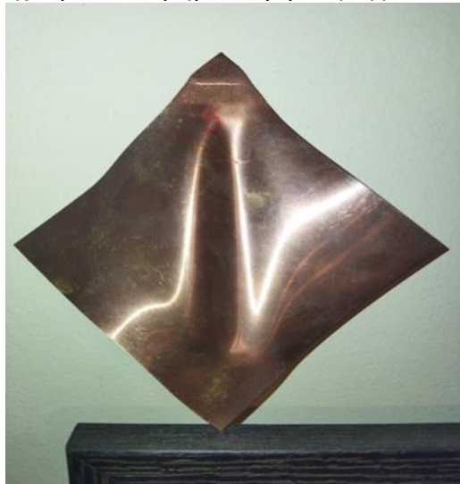
Εικόνα 21 Έλασμα μετά το μονοαξονικό εφελκυσμό
