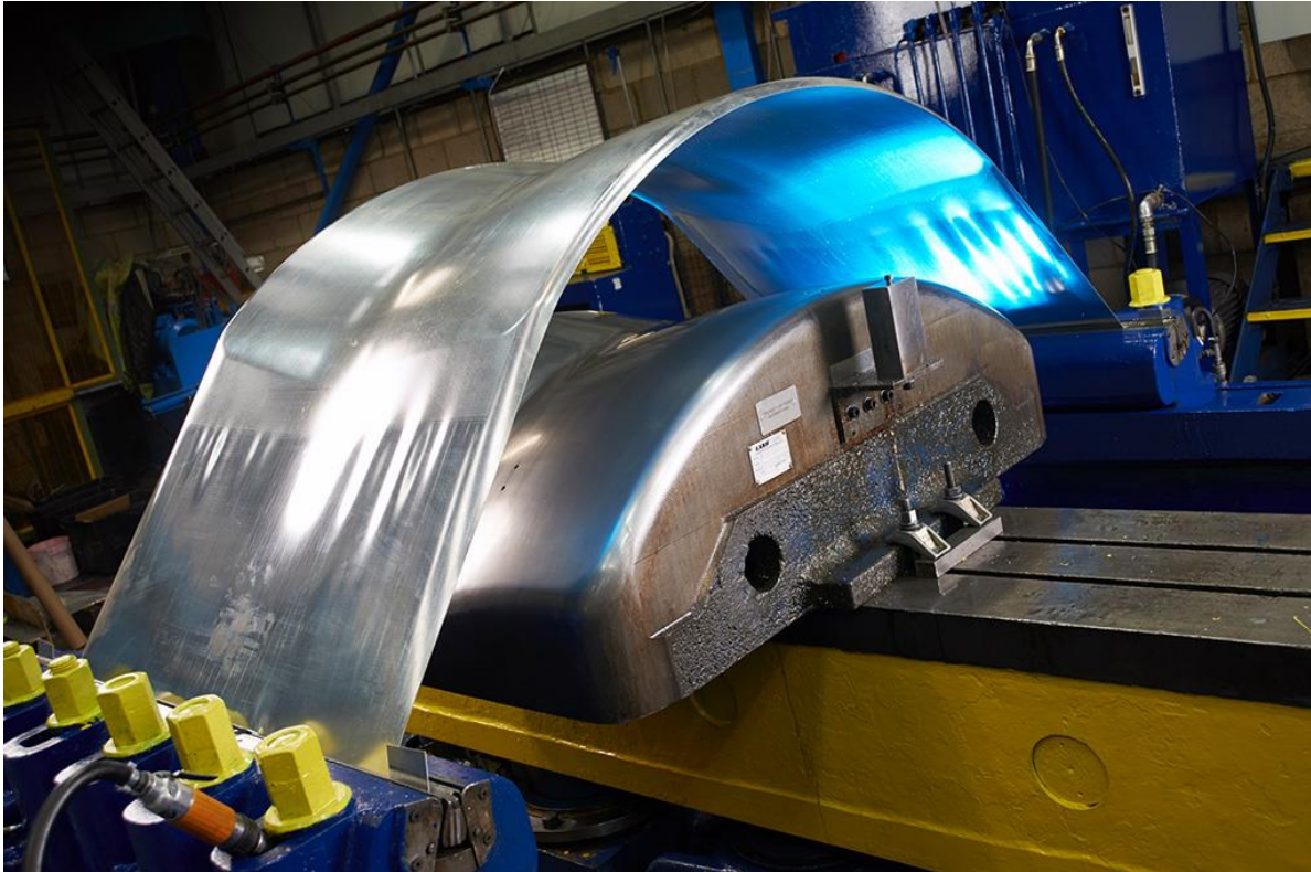
Εικόνα 11 Διαμόρφωση ελάσματος μέσω τεντώματος (stretch forming) για εξωτερικό τμήμα αεροσκάφους Senior Aerospace, Thermal Engineering – Stretch Forming process
