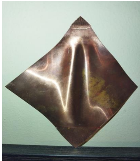
Εικόνα 23 Έλασμα μετά το μονοαξονικό εφελκυσμό
