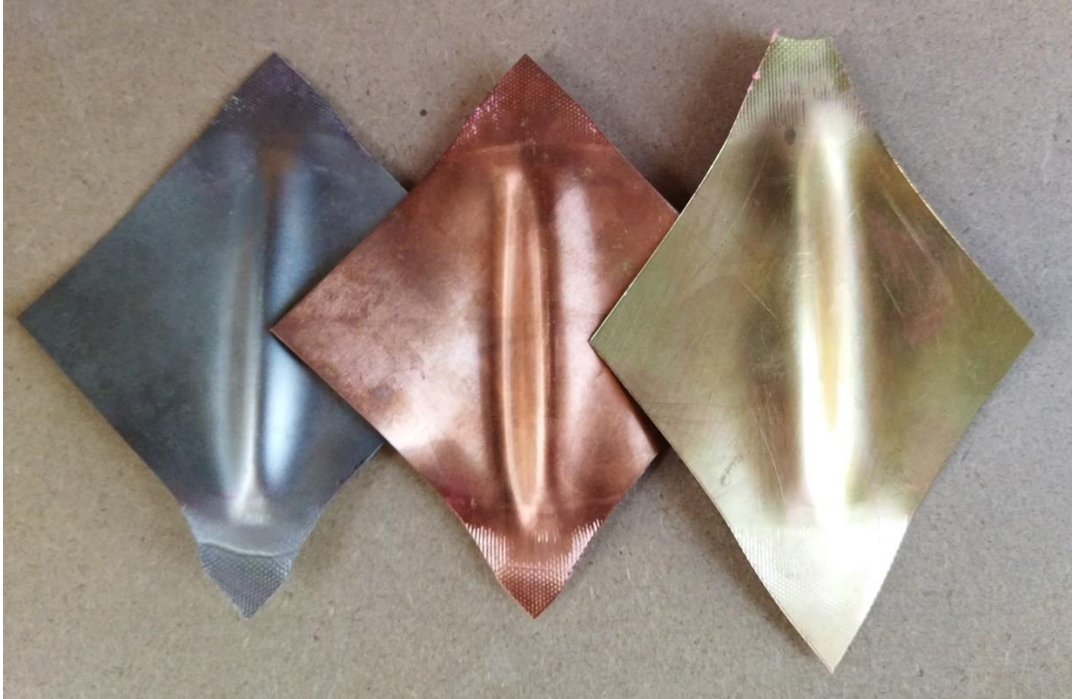
Εικόνα 17 Δοκίμια μεταλλικών ελασμάτων (χάλυβα,χαλκού,ορείχαλκου) μετά το πέρας του πειράματος
