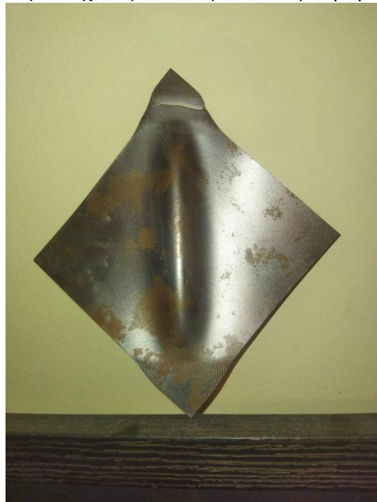
Εικόνα 27 Έλασμα μετά το μονοαξονικό εφελκυσμό
