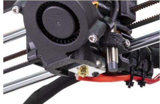
Σχήμα 27: Κεφαλή 3D εκτύπωσης (69)
