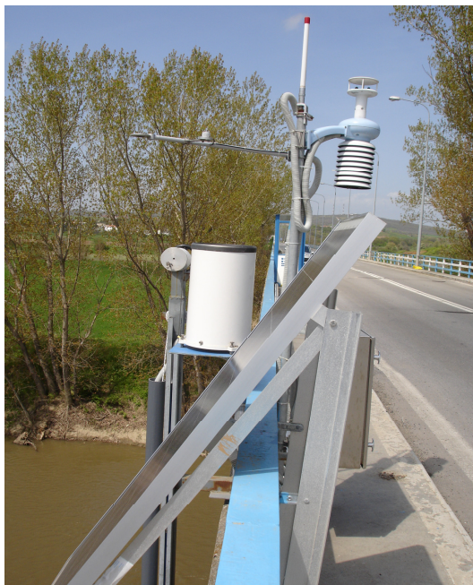
Εικόνα 7.2: Βροχόμετρο, ηλιακός συλλέκτης και καταγραφείς σχετικής υγρασίας και θερμοκρασίας στον σταθμό της γέφυρας Κήπων.
