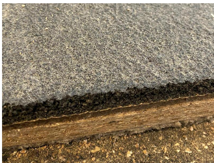
Εικόνα 7: Ηχομονωτικό οδόστρωμα (Πηγή: https://www.metropolitaninsulation.co.uk )
