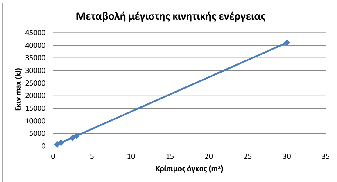
Σχήμα 7.20. Μεταβολή της κινητικής ενέργειας για τα σενάρια με περίοδο επαναφοράς 10, 30, 100 και 300 έτη, για το πρηνές στη Χ.Θ. 387+060 – 387+160
