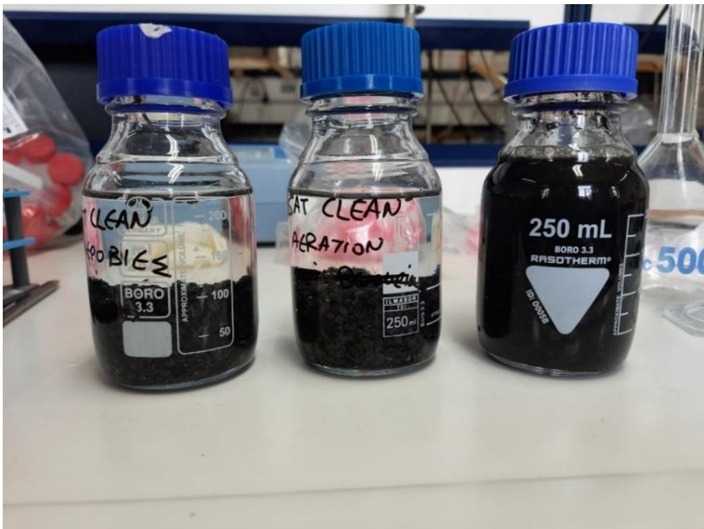
Εικόνα 3.5: Βιοαντιδραστήρες batch συστήματος (Πηγή: Προσωπικό υλικό)
