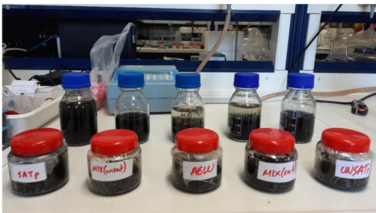
Εικόνα 3.3: Προετοιμασία αντιδραστήρων batch πειραμάτων και αρχικά δείγματα πληρωτικού υλικού από τα πιλοτικά συστήματα τεχνητών υγροβιότοπων (Πηγή: Προσωπικό Αρχείο)
