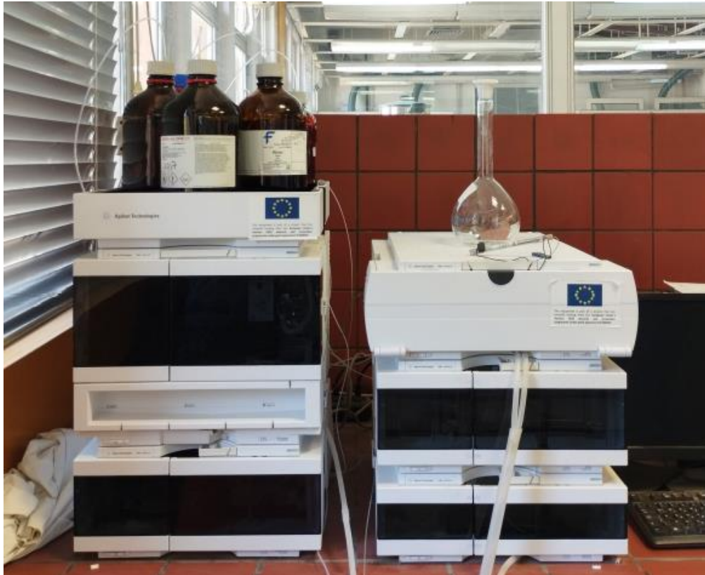
Σχήμα 2.9: Διάταξη Υγρής Χρωματογραφίας Υψηλής Απόδοσης (HPLC) Agilent1260 Infinity II.
