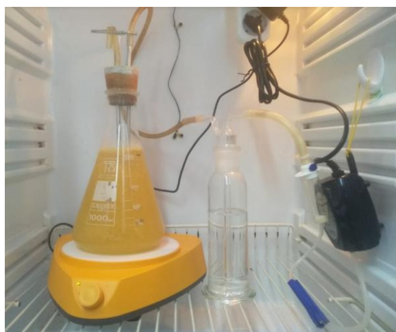
Σχήμα 2.1: Πειραματική διάταξη παραγωγής βιοπλαστικών.
