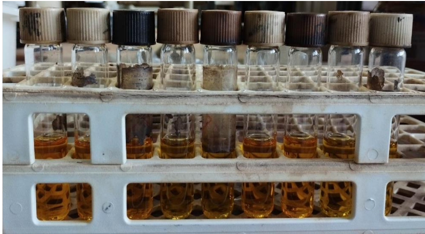
Σχήμα 2.5: Φιαλίδια προς φωτομέτρηση μετά την ολοκλήρωση της οξείδωσης του οργανικού φορτίου
