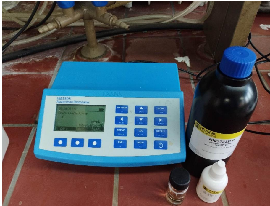
Σχήμα 2.7: Φωτόμετρο Hanna Aquaculture Photometer HI83303 και αντιδραστήρια (HI-93733-01 Ammonia HR kit) για τον προσδιορισμό του αμμωνιακού αζώτου.
