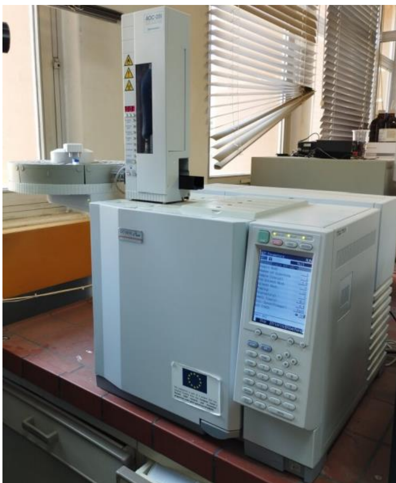
Σχήμα 2.8: Αέριος χρωματογράφος Shimadzu GC-2010 plus με ανιχνευτή φλόγας ιονισμού (FID) για τον προσδιορισμό των Πτητικών Λιπαρών Οξέων (VFAs)
