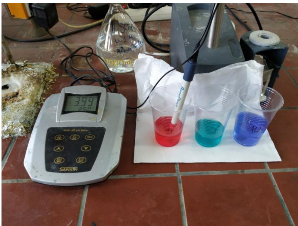
Σχήμα 2.3: Μέτρηση pH με το ηλεκτρονικό πεχάμετρο πάγκου "Sanxin PHS-3D-01 Lab pH Meter" και ηλεκτρόδιο "SensDirect pH electrode type 330"
