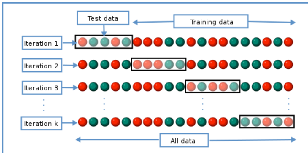
Εικόνα 17: Εικονική αναπαράσταση της Αναζήτησης Πλέγματος (Grid Search). Κάθε γραμμή αφορά μια εποχή εκπαίδευσης και αξιολόγησης ενός συνδυασμού Υπερπαραμέτρων για ένα μοντέλο. Κάθε φορά που εκπαιδεύεται ένα μοντέλο (διαφορετική γραμμή), από το αρχικό Train Set (μια ακολουθία από πράσινες και κόκκινες σφαίρες) επιλέγονται διαφορετικοί συνδυασμοί δειγμάτων για Train και Test Sets. Στο τέλος, τα μοντέλα θα έχουν αξιολογήσει
