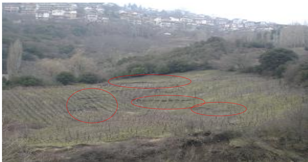
Εικόνα 3.6: Εδαφικές αστοχίες στη βάση του πρανούς του Μετσόβου στον αμπελώνα Κατώγι.
