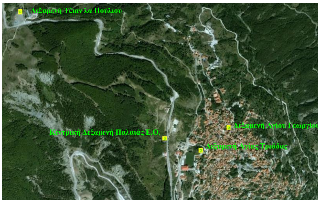
Εικόνα 3.5: Δεξαμενές υδροδότησης του οικισμού του Μετσόβου.
