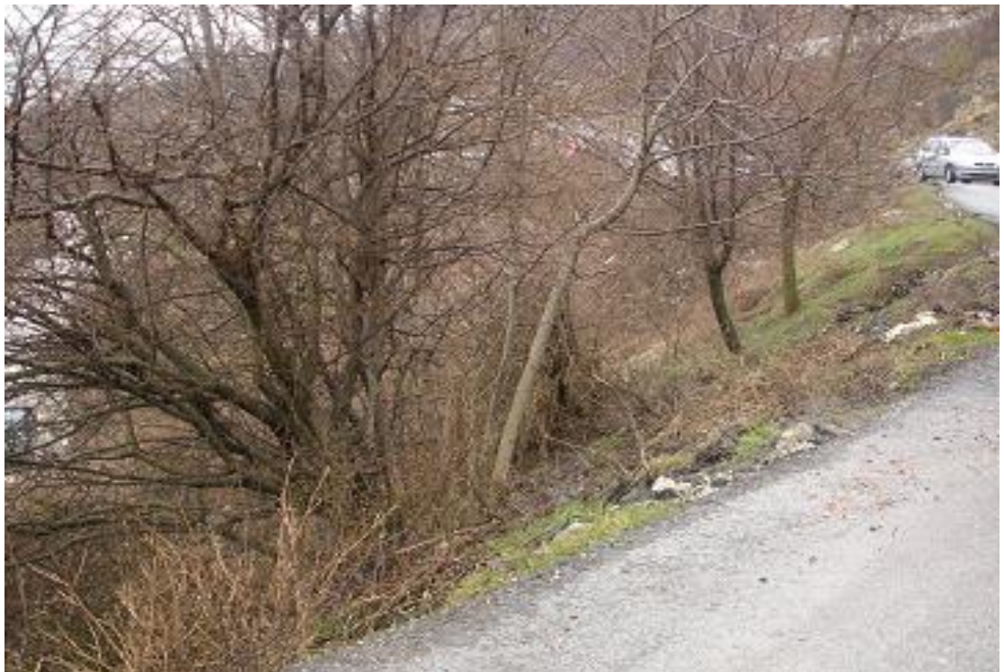
Εικόνα 3.31: Αλλαγή κλίσεως των δέντρων, όπου προκλήθηκε εξαιτίας ερπυσμών και μετακινήσεων.
