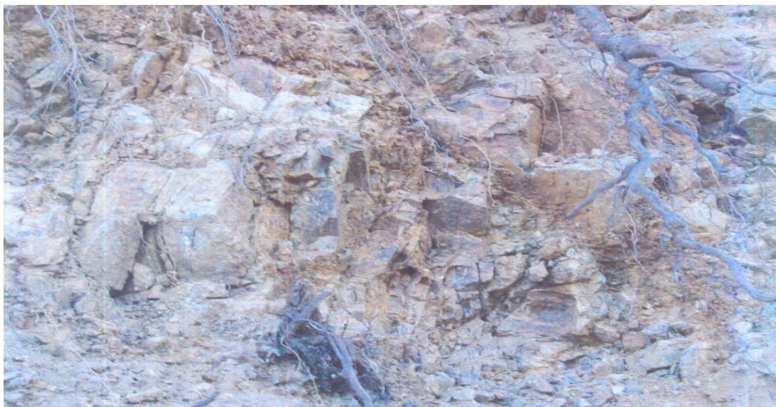
Εικόνα 4.17: Άποψη της κερματισμένης-σχιστοποιημένης-αποσαθρωμένης υπερβασικής οφιολιθικής βραχώμαζας.
