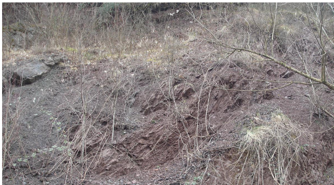
Εικόνα 3.4: Η κόκκινη φάση του φλύσχη στη βάση του πρανούς του Μετσόβου, όπου διακρίνονται οι ερυθροπηλίτες.
