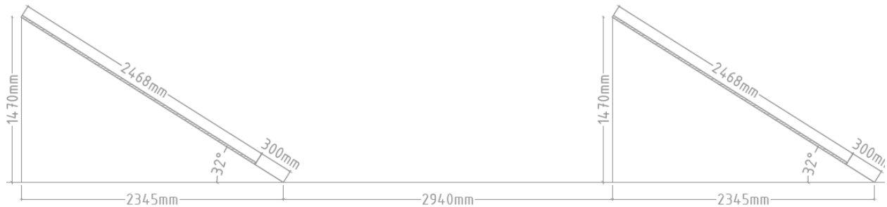
Εικόνα 27 Ενδεικτική χωροθέτηση Φ/Β σταθμού
