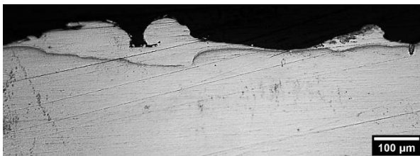
Εικόνα 87: Συνθήκες: I_p = 24 [A] , t_{on} = 500 [\mu sec] - μεγέθυνση 10x
