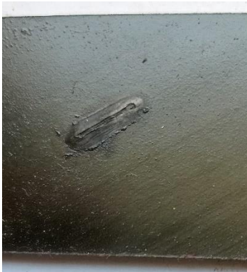
Εικόνα 77: Αποτέλεσμα εμφάνισης τόξου DC Εικόνα 78: Επιτυχημένη απόπειρα κατεργασίας
