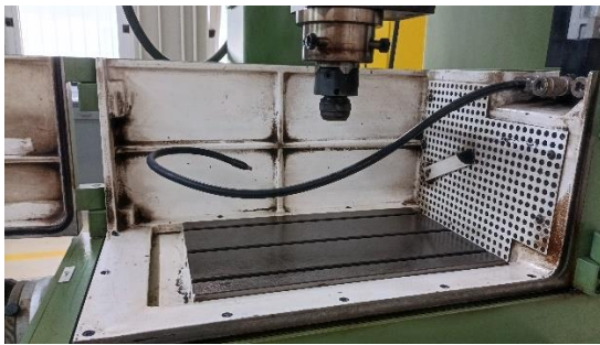
Εικόνες 26, 27: Το εσωτερικό και το πορτάκι του δοχείου εργασίας της μηχανής AGIETRON EMT 1.10
