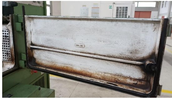
Εικόνες 26, 27: Το εσωτερικό και το πορτάκι του δοχείου εργασίας της μηχανής AGIETRON EMT 1.10
