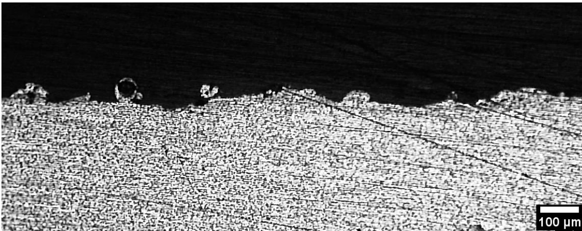
Εικόνα 95: Συνθήκες: I_p = 21 [A] , t_{on} = 100 [\mu sec] - μεγέθυνση 10x
