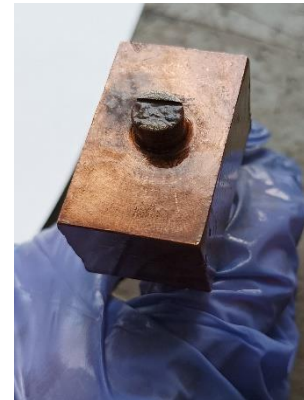
Εικόνα 76: Φθορά του ηλεκτροδίου μετά την κατεργασία καρβιδίου
