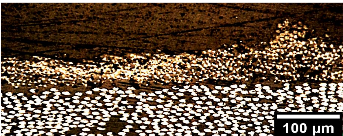
Εικόνα 132: Μεγέθυνση 50x - Συνθήκες: I_p = 1.5 [A] , t_{on} = 500 [\mu sec]
