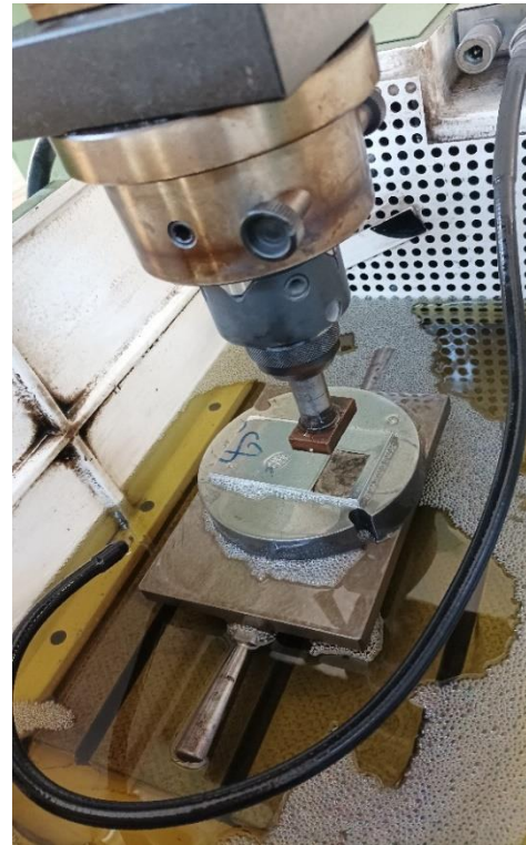
Εικόνα 58: Ολοκληρωμένη κατεργασία EDM στην πλάκα αλουμινίου
