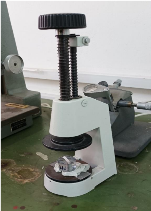
Εικόνα 68: Στερέωση δοκιμίου στο πλακίδιο
