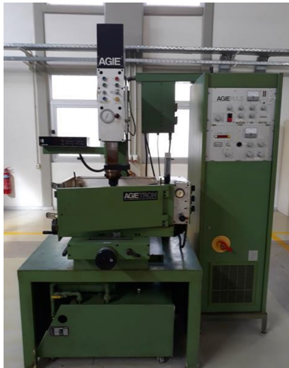
Εικόνα 43: Η μηχανή AGIETRON EMT 1.10 [10]
