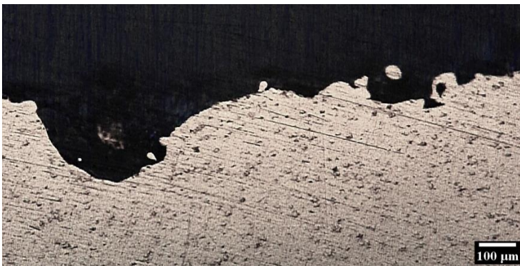
Εικόνα 111: Συνθήκες: I_p = 24 [A] , t_{on} = 300 [\mu sec] - μεγέθυνση 10x
