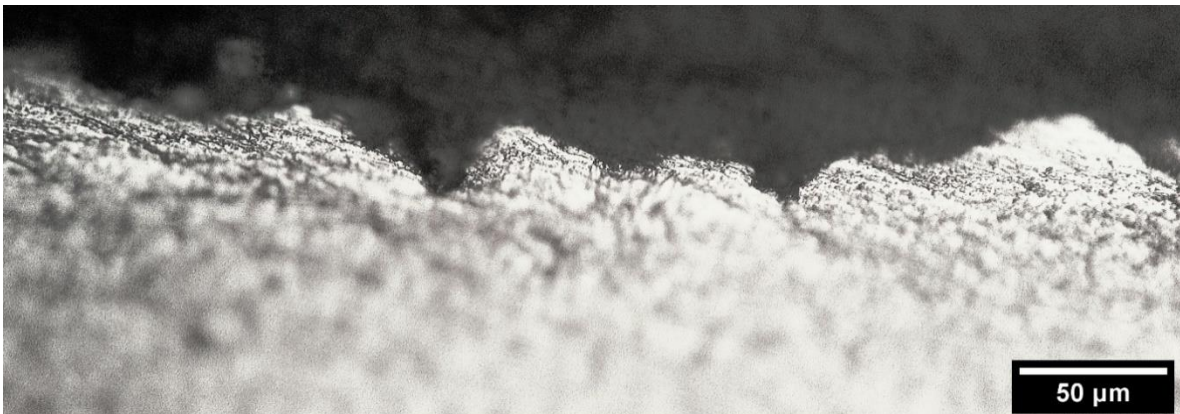
Εικόνα 125: Μεγέθυνση 50x - Συνθήκες: I_p = 16.5 [A] , t_{on} = 50 [\mu sec]
