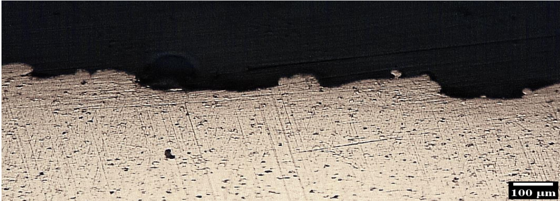
Εικόνα 107: Συνθήκες: I_p = 24 [A] , t_{on} = 100 [\mu sec] - μεγέθυνση 10x
