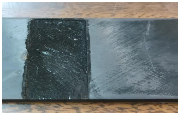
Εικόνα 77: Αποτέλεσμα εμφάνισης τόξου DC Εικόνα 78: Επιτυχημένη απόπειρα κατεργασίας
