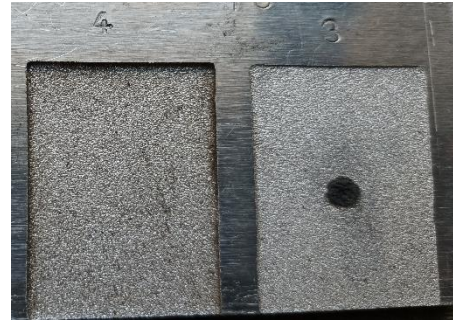
Εικόνα 72: Το εμφανές σημάδι τόξου DC στην επιφάνεια κατεργασίας
