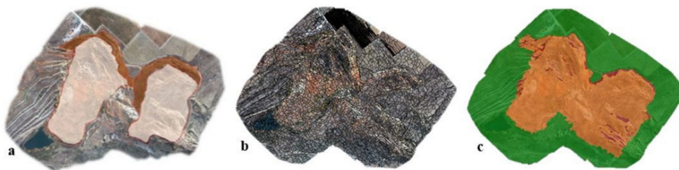
Σχήμα 4.36: α) Ορθοφωτογραφία που επικαλύπτεται από τα δεδομένα αναφοράς, β) το αποτέλεσμα τμηματοποίησης και γ) η τελική ταξινόμηση μετά την τελειοποίηση της μεθόδου που βασίζεται σε κανόνες για τη δομή RGB-DSM (πράσινο: μη επηρεασμένο, ανοιχτό καφέ: εξάντληση, σκούρο καφέ: scarp) (Karantanellis et al., 2021).
