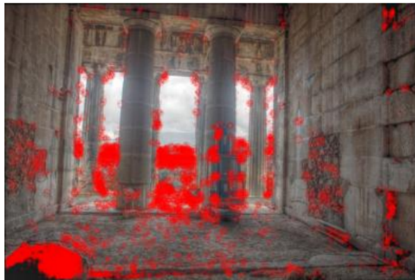
Σχήμα 4.11: Εντοπισμός χαρακτηριστικών σημείων με ORB (a) για SDR εικόνα (8144 points) και (b) για HDR εικόνα (20000 points) (Kontogianni et al., 2015).
