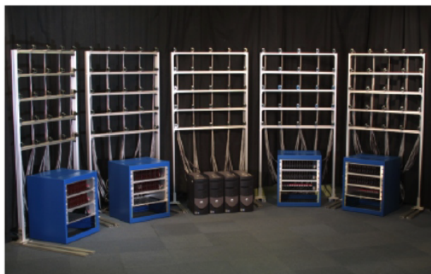
Σχήμα 2.3: Συστοιχία καμερών σε μορφή πινάκα, από το πανεπιστήμιο του Stanford, που λαμβάνουν πολλαπλές φωτογραφίες ταυτόχρονα (με μερικώς διαφοροποιημένες θέσης λήψης - epsilon changes in parametr over sensors), (Πηγή: Computational Photography Raskar-Tumblin).
