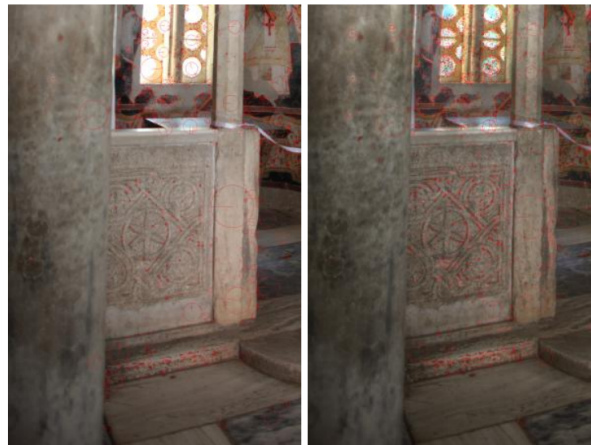
Σχήμα 4.9: Εντοπισμός χαρακτηριστικών σημείων με SIFT (a) για SDR εικόνα και (b) για HDR εικόνα (Kontogianni et al., 2015).
