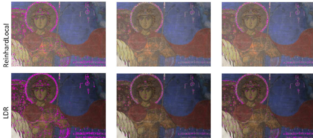
Σχήμα 4.21: Σημεία κλειδιά που εντοπίστηκαν για κάθε LDR εικόνα σε συνδυασμό με τους ανιχνευτές FAST, SURF, SIFT για τοιχογραφία από τον Ι.Ν.Π της Ασίνου (Suma et al., 2016).
