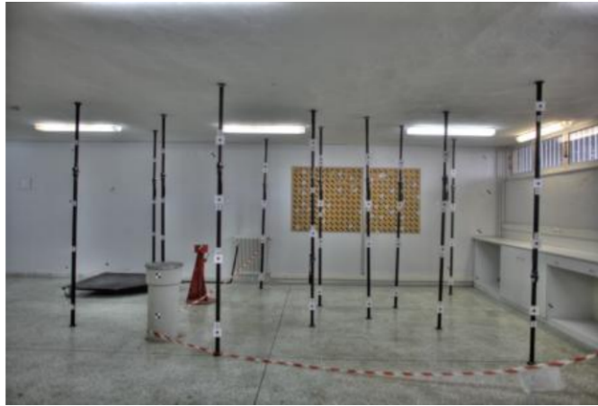
Σχήμα 4.4: (α) Φωτογραφία με ΟΕV στο πεδίο ελέγχου βαθμονόμησης με φακό 24mm, (β) η αντίστοιχη HDR εικόνα (Ntregka et al., 2013).
