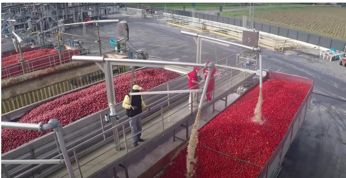
Εικόνα 1: Διεργασία μεταφοράς της πρώτης ύλης από τα φορτηγά στο ρυάκι, flume [11] .
