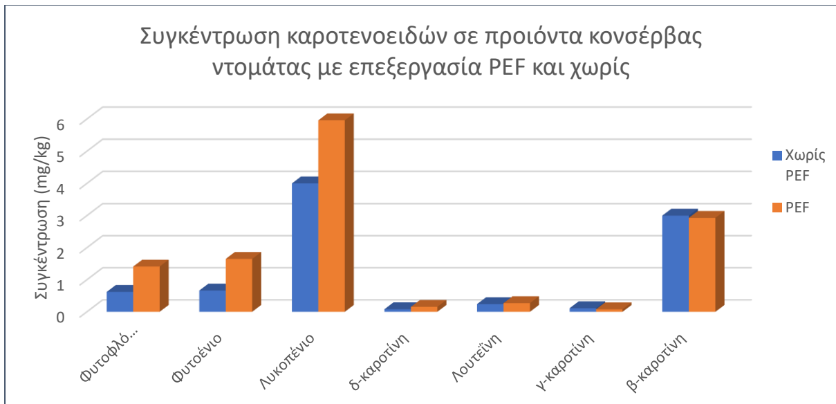
Διάγραμμα 22: Σύγκριση συγκεντρώσεων καροτενοειδών σε δείγμα κονσέρβας ντομάτας που έχει επεξεργαστεί με PEF και δείγματος που δεν έχει υποστεί επεξεργασία [70] .
