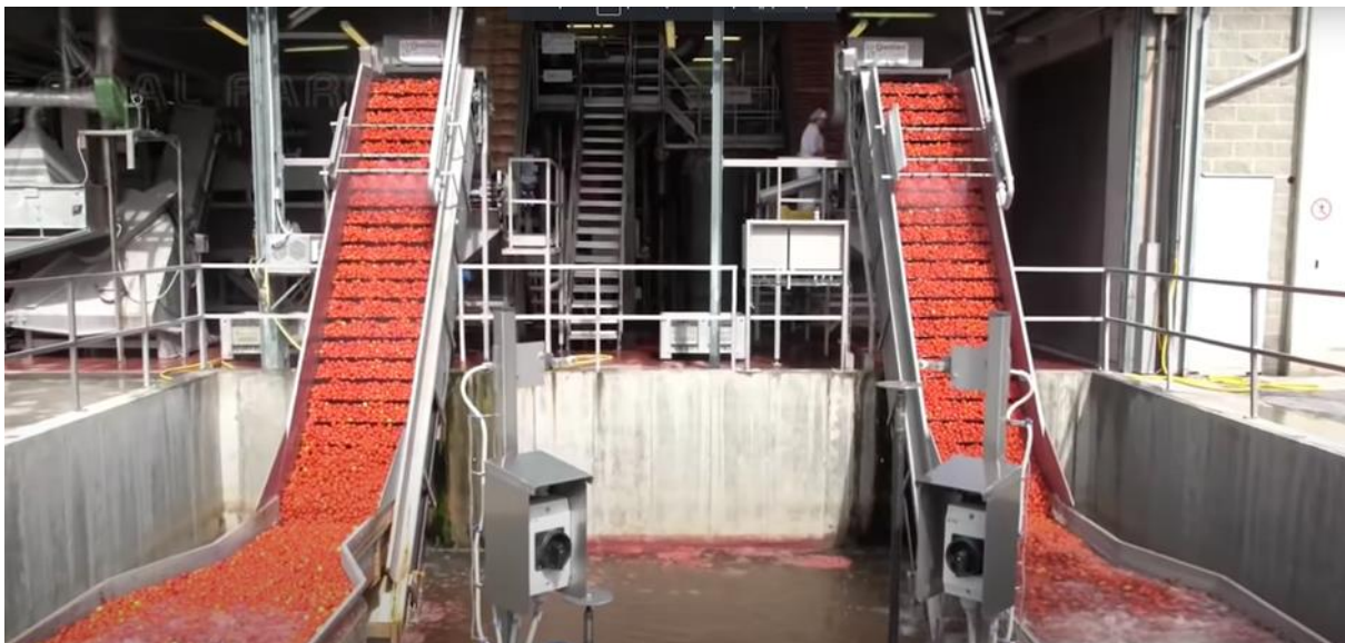
Εικόνα 3: Ιμάντες ανύψωσης στο τέλος της διεργασίας πλυσίματος και ψεκαστήρες πόσιμου νερού για ξέβγαλμα.
