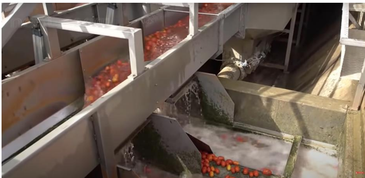
Εικόνα 2: Απεικόνιση flume μεταλλικής (πάνω μέρος) και τσιμεντένιας κατασκευής (κάτω μέρος).
