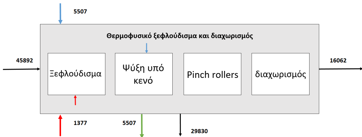
Διάγραμμα 4: Διάγραμμα ροής για το στάδιο ξεφλούδισματος μαζί με τις ποσότητες των ρευμάτων.
