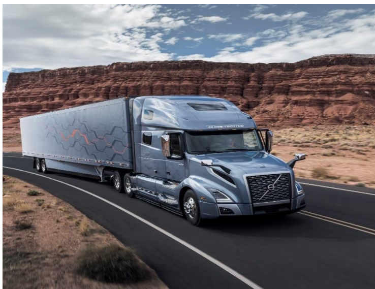
Εικόνα 2-6: Βαρύ όχημα μελέτης βάση κανονισμών AASHTO (125kg/kw)
