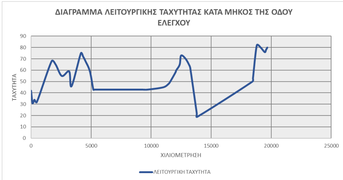
Σχήμα 3-62: Διάγραμμα λειτουργικής ταχύτητας κατά μήκος της οδού ελέγχου
