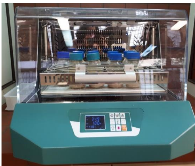
Σχήμα 14: Ανακινούμενο αερόλουτρο IKA KS 30001 control.
