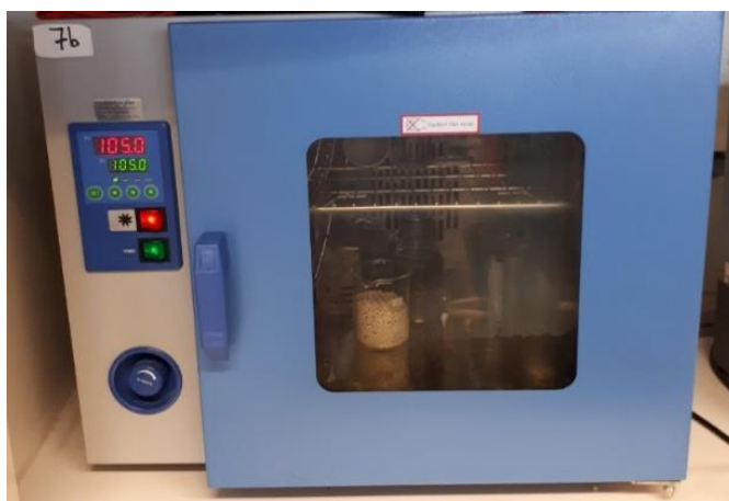
Σχήμα 10: Φούρνος ξήρανσης Carbolite.
