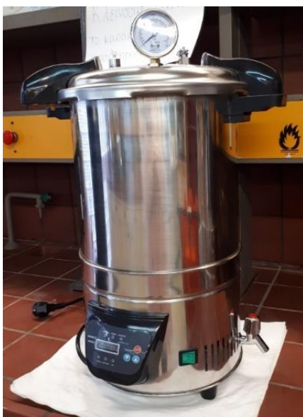
Σχήμα 15: Κλίβανος αποστείρωσης ISOLAB Laborgerate GmbH Autoclave.
