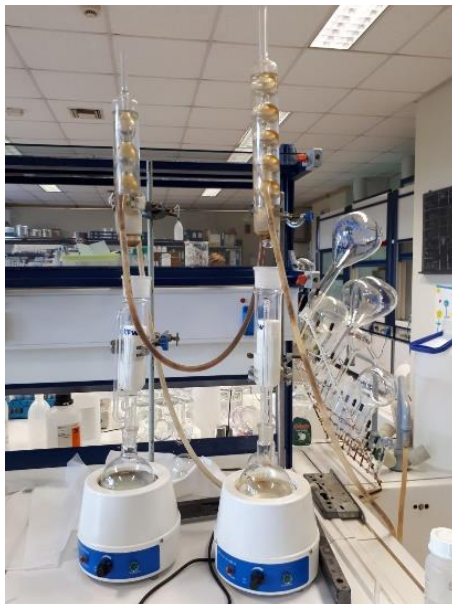
Σχήμα 13: Διάταξη της Soxhlet.
