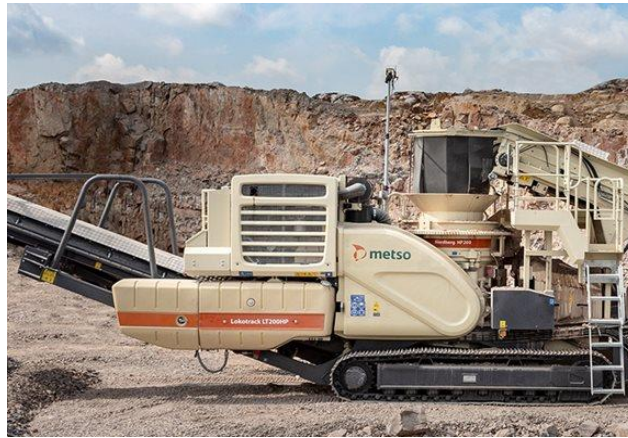
Εικόνα 3.6 Κινητή μονάδα θραύσης METSO
