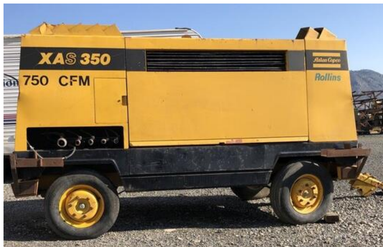
Εικόνα 3.2 Αεροσυμπιεστής ATLAS COPCO των 750ft
