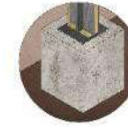
ΠΑΚΤΟΣΗ στήριξη υποστυλώματος
