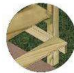
ΣΤΗΡΙΞΗ σανίδες- υποστύλωμα - δοκός
