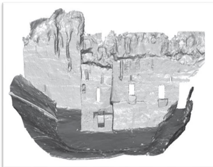
Εικόνα 3.13: Το τελικό μοντέλο του σπηλαίου της νεκρόπολης, το οποίο έχει προκύψει με την χρήση διαφορετικών μεθόδων, ανάμεσα στις οποίες και η τεχνολογία SLAM (Rabbia et al., 2020)
