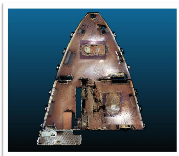
Εικόνα 7.15: Κάτοψη με τομή από την οροφή, του τρισδιάστατου νέφους σημείων των ναυαρχικών διαμερισμάτων, που αποκτήθηκε με τον σαρωτή ZEB Horizon
