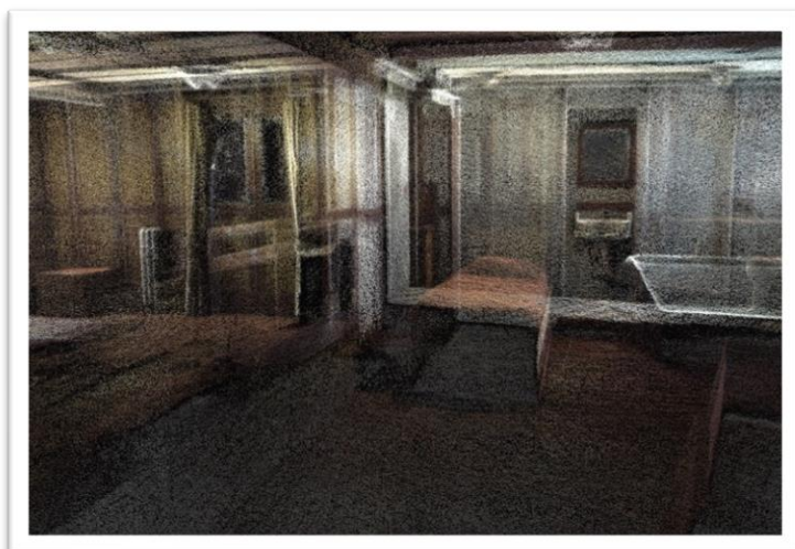
Εικόνα Α.9: Στιγμιότυπα της εικονικής περιήγησης, μέσα στο τρισδιάστατο νέφος σημείων των ναυαρχικών διαμερισμάτων, που αποκτήθηκε με τον σαρωτή ZEB Horizon
