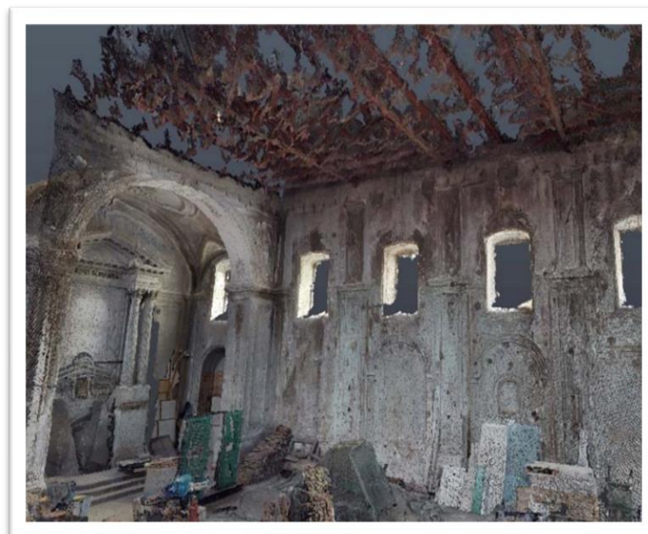
Εικόνα 3.27: Απουσία τμημάτων στο νέφος σημείων της εκκλησίας που αποκτήθηκε με την κάμερα Matterport Pro2 3D (Pulcrano et al., 2019)
