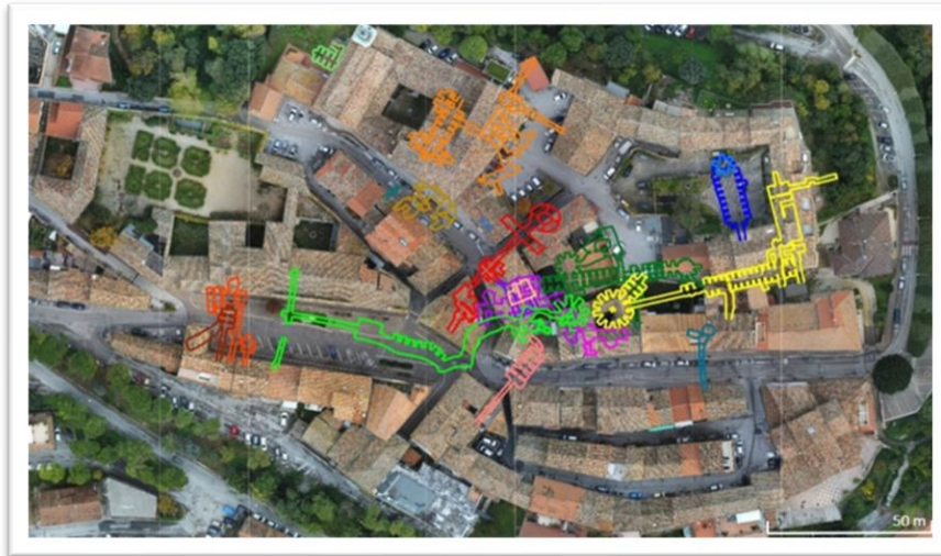
Εικόνα 3.14: Υπέρθυση της υπόγειας σπηλιάς, μήκους περίπου 3km, πάνω στη πόλη Camerano στην Ιταλία (Di Stefano et al., 2021)
