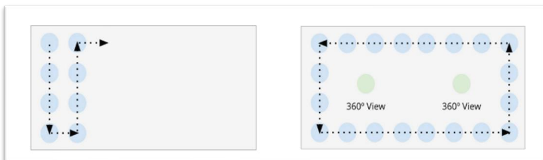
Εικόνα 6.7: Αριστερά η διαδρομή λήψης των δεδομένων με την κάμερα Matterport Pro2 3D που πρέπει να αποφεύγεται και δεξιά η διαδρομή που συνίσταται (Matterport, 2020)
