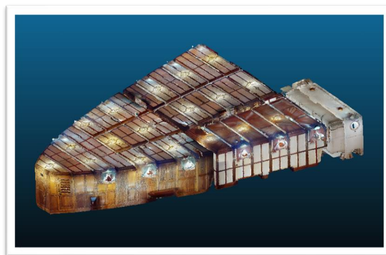
Εικόνα 7.30: Το τρισδιάστατο νέφος σημείων των ναυαρχικών διαμερισμάτων, που αποκτήθηκε με την κάμερα Matterport Pro2 3D
