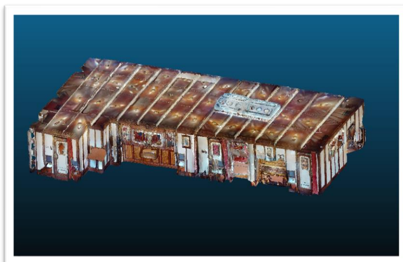
Εικόνα 7.28: Το τρισδιάστατο νέφος σημείων του καρέ αξιωματικών, που αποκτήθηκε με την κάμερα Matterport Pro2 3D
