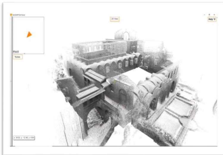
Εικόνα 3.16: Τρισδιάστατη οπτικοποίηση και πλοήγηση στο νέφος σημείων του παλατιού, χρησιμοποιώντας το λογισμικό Geoslam Hub (Patrucco et al., 2019)
