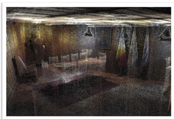
Εικόνα Α.8: Στιγμιότυπα της εικονικής περιήγησης, μέσα στο τρισδιάστατο νέφος σημείων του καρέ αξιωματικών, που αποκτήθηκε με τον σαρωτή ZEB Horizon
