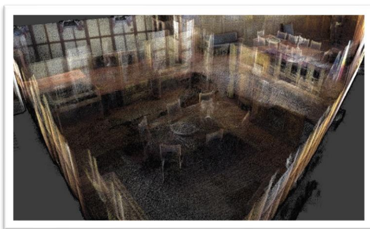
Εικόνα 7.17: Στιγμιότυπο της εικονικής περιήγησης, μέσα στο τρισδιάστατο νέφος σημείων των ναυαρχικών διαμερισμάτων, που αποκτήθηκε με τον σαρωτή ZEB Horizon
