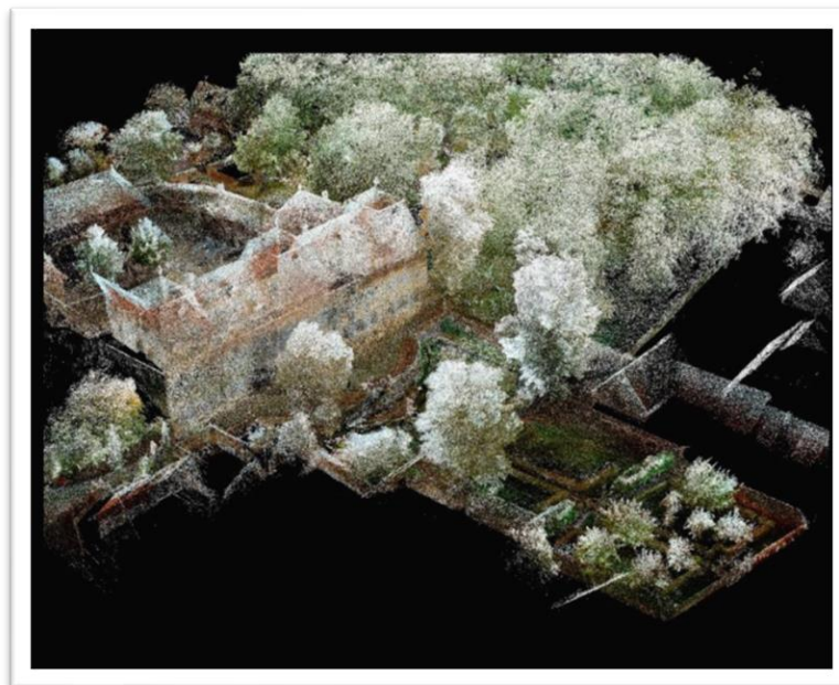
Εικόνα 3.11: Τρισδιάστατο χρωματισμένο νέφος σημείων των κήπων, μέρος των αποτελεσμάτων που προέκυψαν με την χρήση της τεχνολογίας SLAM (Hess & Ferreyra, 2021)
