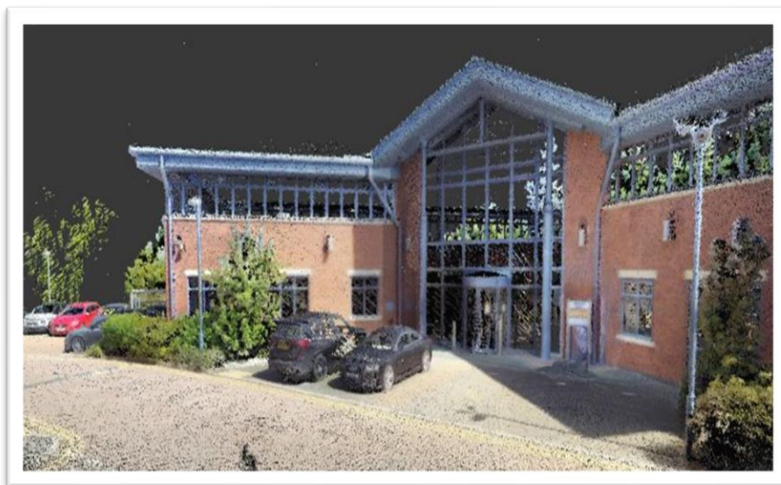
Εικόνα 6.3: Χρωματισμένο νέφος σημείων των κεντρικών γραφείων της εταιρίας GeoSLAM, που καταγράφηκε με την χρήση της κάμερα ZEB Vision (GeoSLAM, n.d.)
