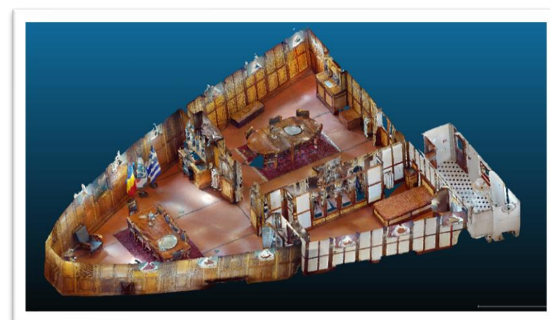
Εικόνα 7.31: Πλάγια όψη με τομή από την οροφή, του τρισδιάστατου νέφους σημείων των ναυαρχικών διαμερισμάτων, που αποκτήθηκε με την κάμερα Matterport Pro2 3D
