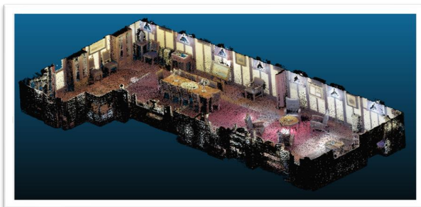
Εικόνα Α.6: Πλάγια όψη με τομή από την οροφή, του τρισδιάστατου νέφους σημείων του καρέ αξιωματικών, που αποκτήθηκε με τον σαρωτή ZEB Horizon
