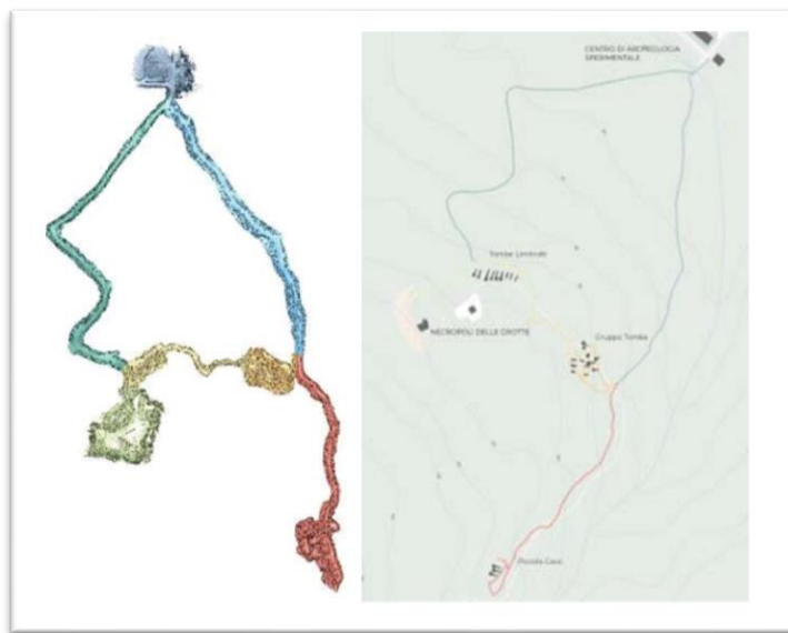
Εικόνα 3.12: Το νέφος σημείων που προέκυψε με την χρήση του οργάνου Zeb Revo που βασίζεται στην τεχνολογία SLAM, μετά την διαδικασία της συγχώνευσης (Rabbia et al., 2020)
