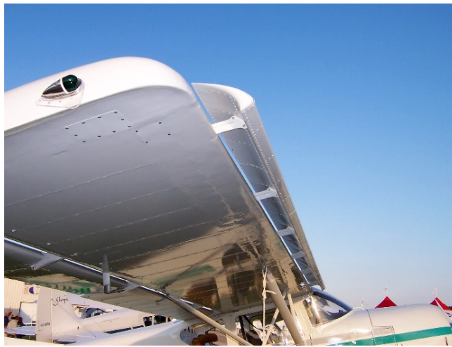
Σχήμα 17 : Το διάκενό μεταξύ του slat και της κύριας πτέρυγας σε ένα αεροσκάφος STOL
