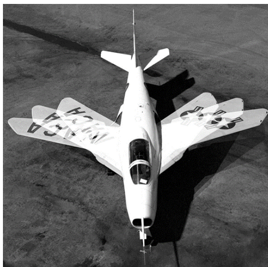
Σχήμα 7 : Οι διαφορετικές διαμορφώσεις της οπισθόκλισης που λάμβανε η πτέρυγα του Bell X-5
