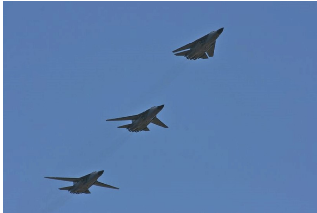
Σχήμα 15 : Το F-111 Aardvark σε πτήση με διαφορετικές γωνίες οπισθόκλισης της πτέρυγας του
