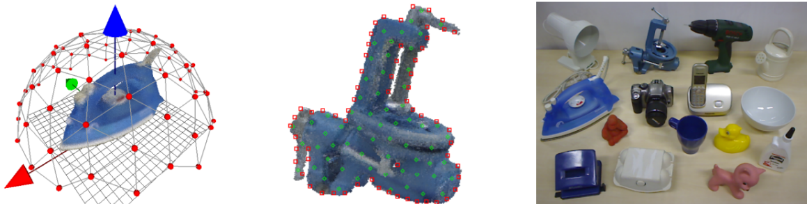
Σχήμα 27: Η μέθοδος των Hinterstoisser et al. [2012]. Αριστερά: η συστηματική συλλογή συνθετικών εικόνων του αντικειμένων. Στη μέση: τα χαρακτηριστικά σημεία που επιλέγονται στην επιφάνεια του αντικειμένου μέσω της αλλαγής χρώματος (color gradient - κόκκινα) αλλά και τα διανύσματα των επιφανειών (surface normals - πράσινα). Δεξιά: Αντικείμενα που χρησιμοποιήθηκαν
