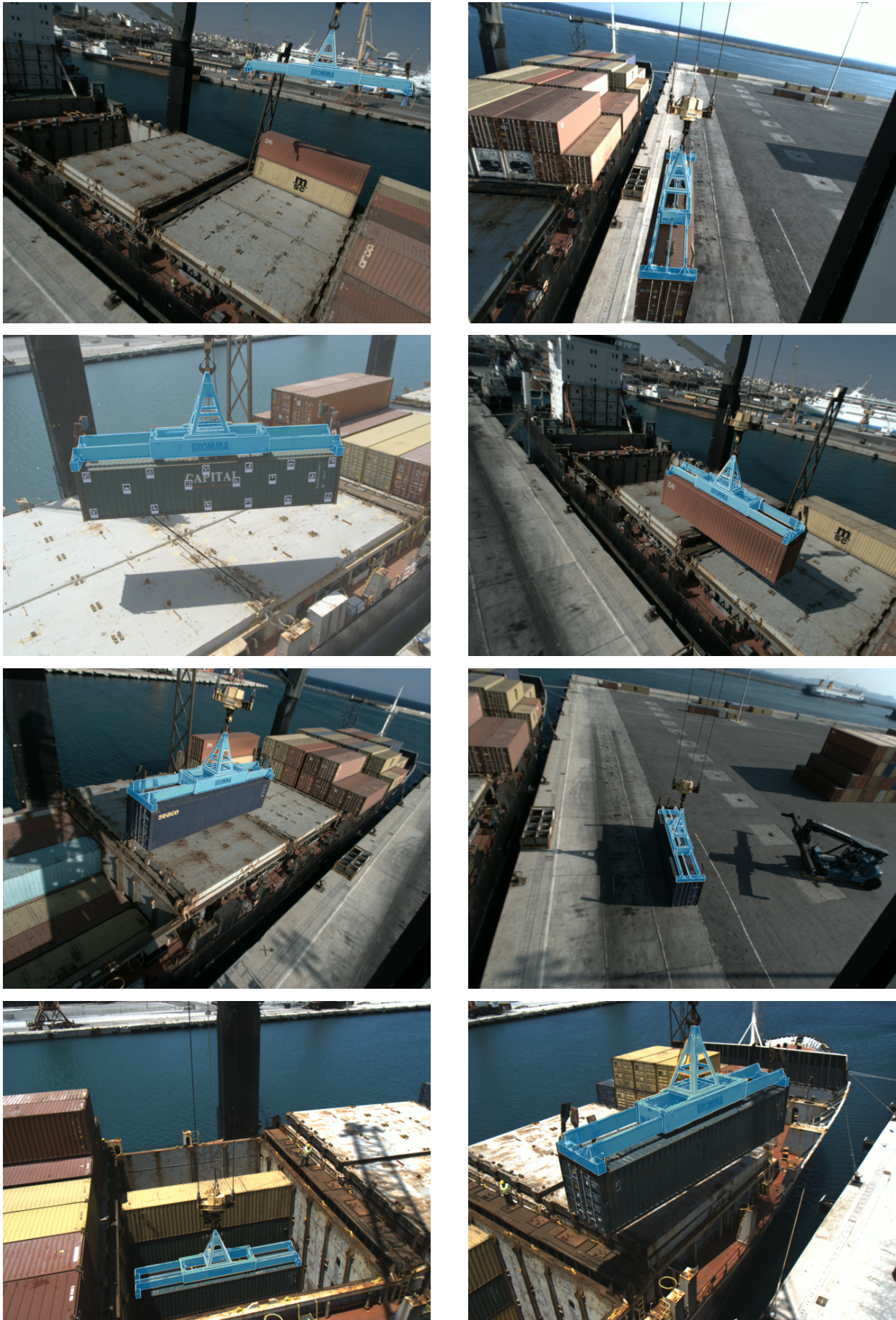
Σχήμα 67: Οι εκτιμώμενες πόζες μετασηματισμένες στο format των αρχικών εικόνων. Με άσπρο χρώμα έχει γίνει η υπέρθεση των ορατών ακμών (διακρίνονται καλύτερα σε μεγέθυνση) και με μπλε ημιδιάφανο χρώμα φαίνεται το 3D μοντέλο της αρπάγης
