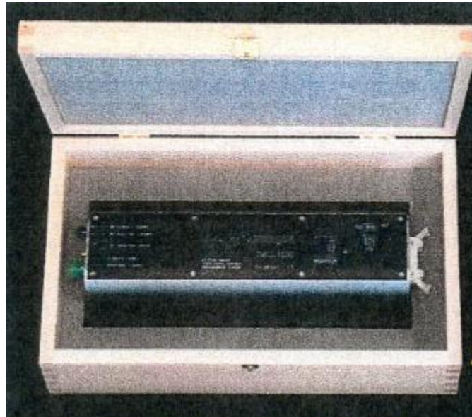
Εικόνα 4.2.2.1: Το MLL που χρησιμοποιήθηκε για την παλμο-σειρά με repetition rate στα 10GHz.
