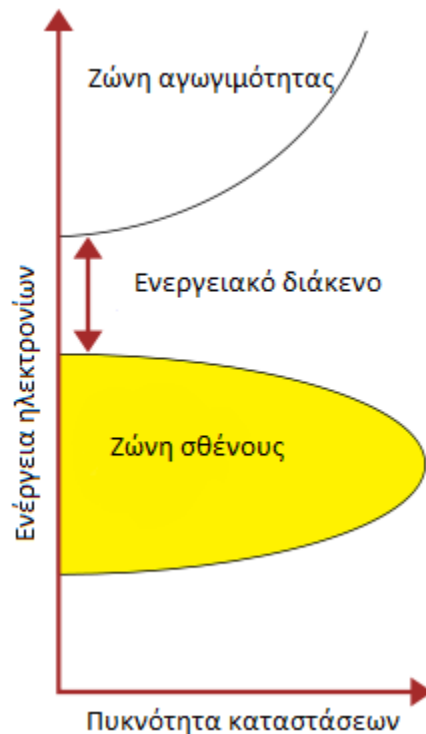
Εικόνα 2.5.6.1: Διάγραμμα ενέργειας ηλεκτρονίων σε συνάρτηση με την πυκνότητα των καταστάσεων
