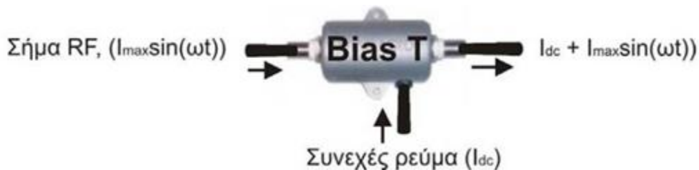
Εικόνα 4.2.2.3: Η αρχή λειτουργίας του Bias T.
