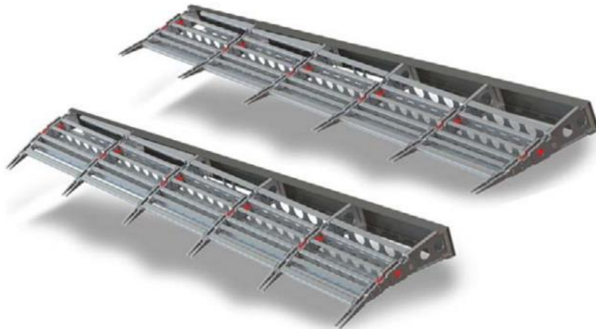
Εικόνα 6: Αρθρωτός μηχανισμός μεταβολής της ακμής εκφυγής [1]
