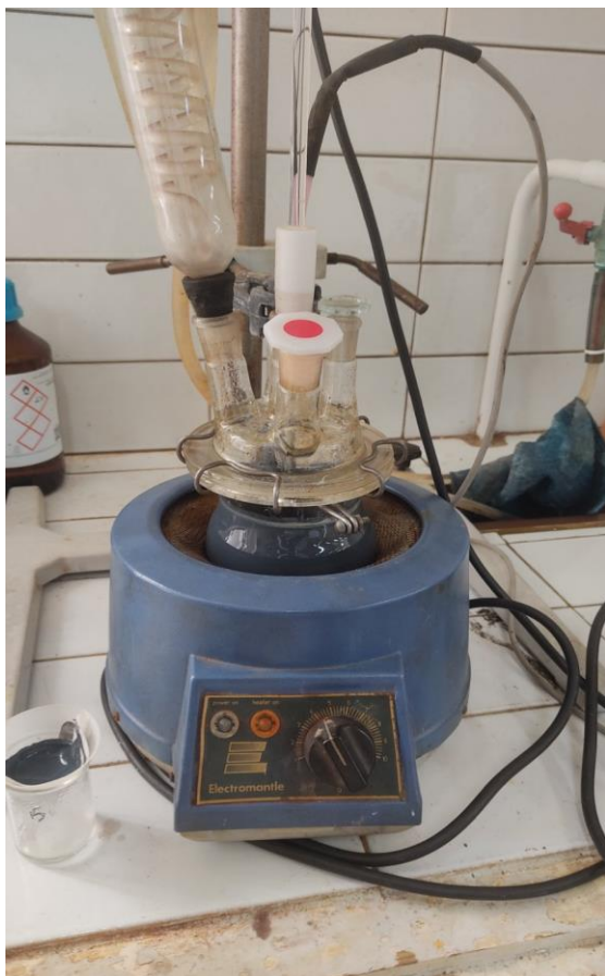
Εικόνα 6.14: Αντιδραστήρας εκχύλισης τοποθετημένος σε θερμομανδύα.
