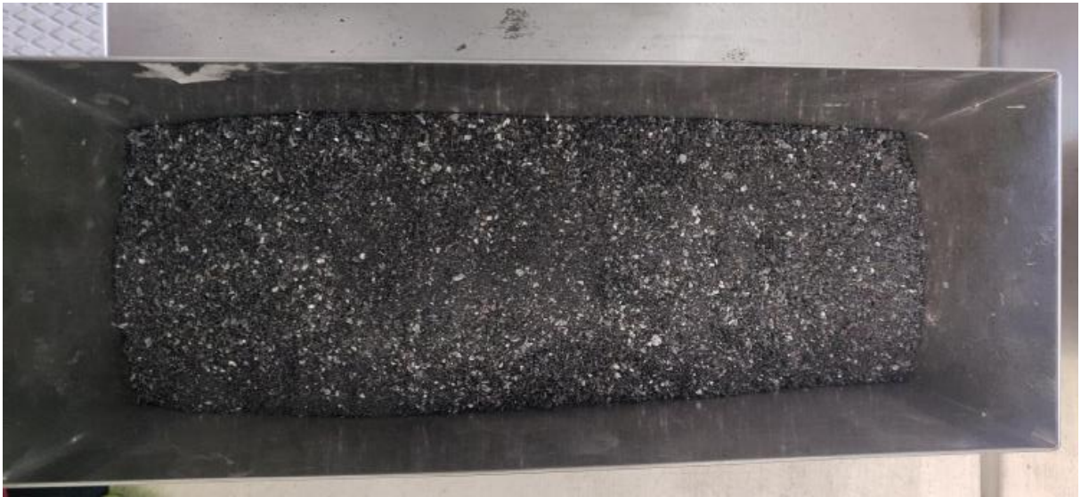
Εικόνα 6.4 : Οι μπαταρίες μετά τη λειοτρίβηση στο μύλο Retsch SM 2000 της εταιρείας MetalLogic
