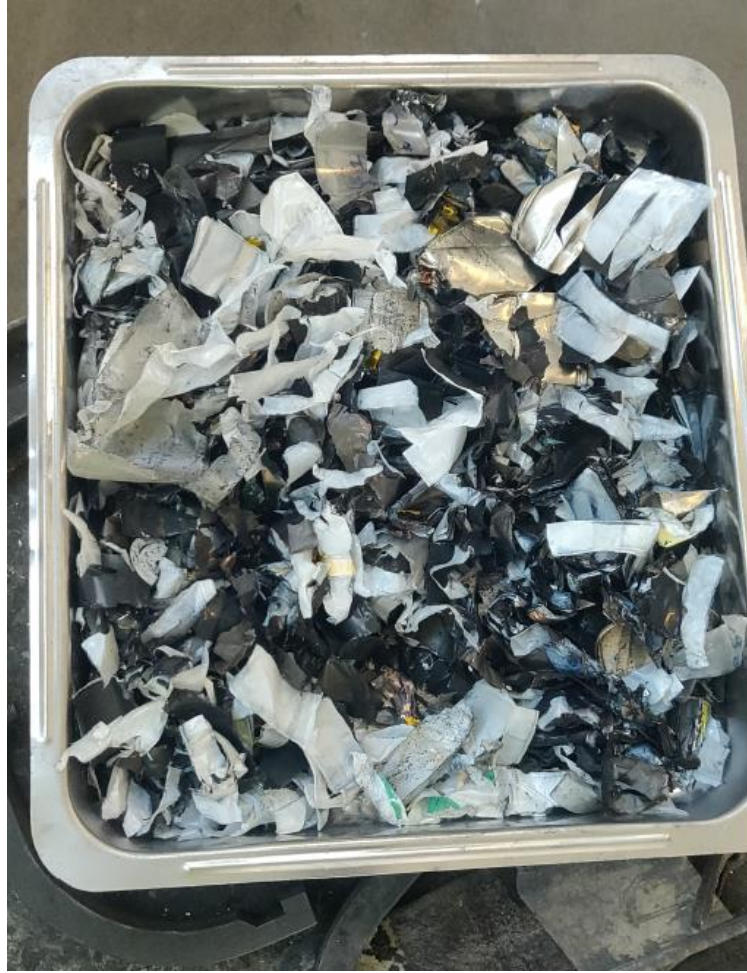
Εικόνα 6.2: Οι μπαταρίες μετά την πρώτη θραύση στα ψαλίδια – κροκόδειλους της εταιρείας MetalLogic
