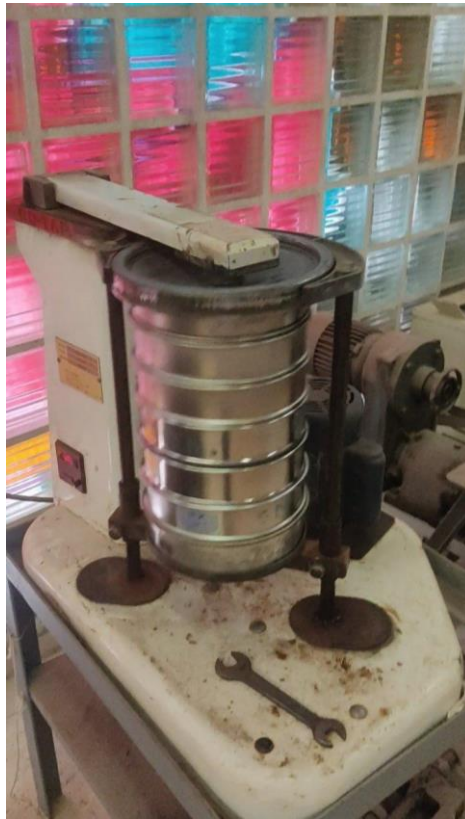
Εικόνα 6.8: Δομητής κοσκίνων μοντέλου RX-29 και τύπου ROTAP στο Εργαστήριο Εμπλουτισμού της σχολής Μηχανικών Μεταλλείων - Μεταλλουργών, ΕΜΠ
