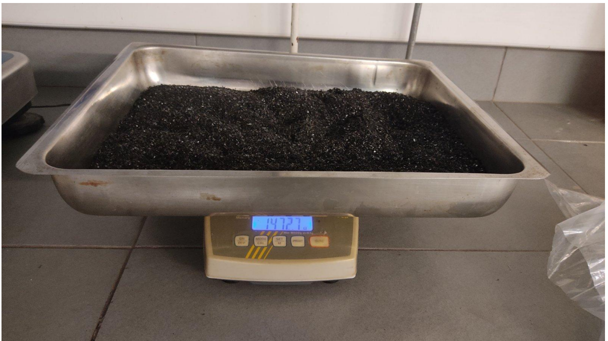
Εικόνα 6.5: Μάζα του συνόλου του υλικού μετά τη θραύση- λειοτρίβηση των 12 μπαταριών LFP
