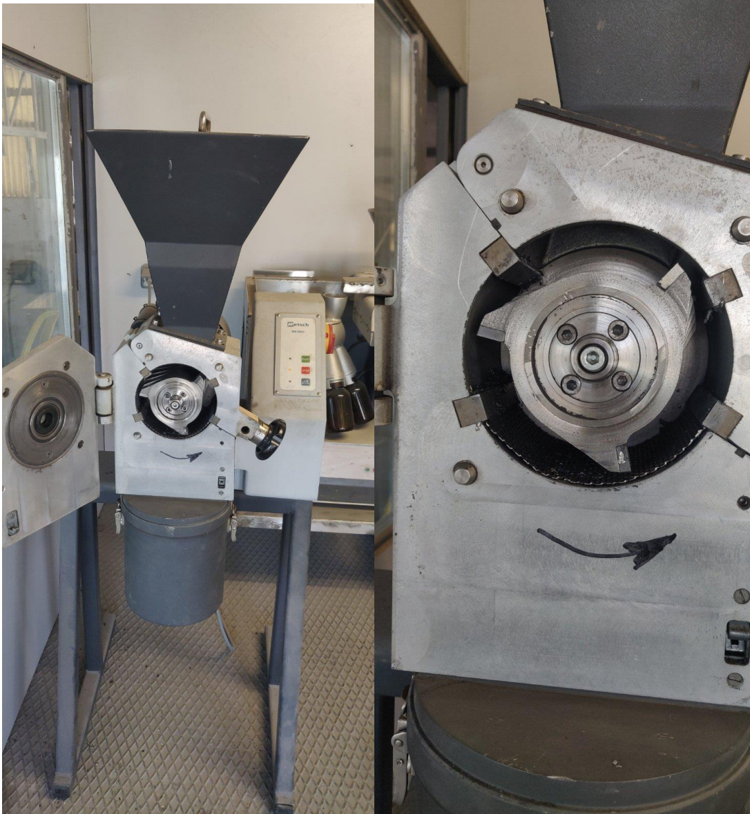
Εικόνα 6.3: Ο μύλος λειοτρίβησης Retsch SM 2000 της εταιρείας MetalLogic
