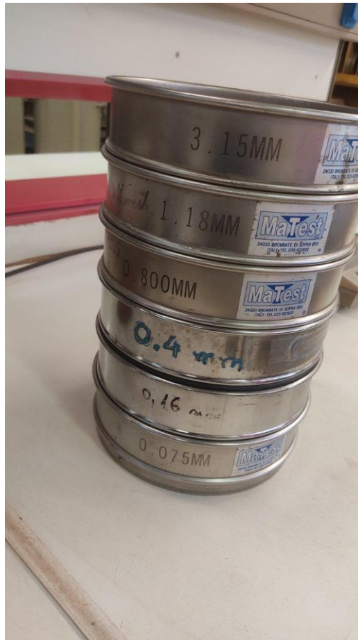
Εικόνα 6.9: Διάταξη κοσκίνων (3,15 mm ( \Delta 1 : +3,15 mm), 1,18 mm ( \Delta 2 : -3,15 mm + 1,18 mm), 800 \mu\text{m} ( \Delta 3 : -1,18mm + 800 \mu\text{m} ), 400 \mu\text{m} ( \Delta 4 : -800 \mu\text{m} + 400 \mu\text{m} ), 160 \mu\text{m} ( \Delta 5 : - 400 \mu\text{m} + 160 \mu\text{m} ), 75 \mu\text{m} ( \Delta 6 : -160 + 75 \mu\text{m} ))
