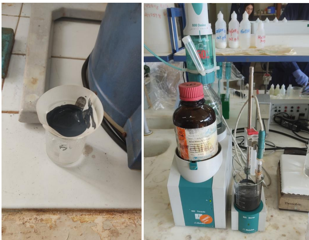
Εικόνα 6.15: α) Διήθηση δείγματος εκχύλισης β) Μέτρηση pH του κυοφορούντος διαλύματος
