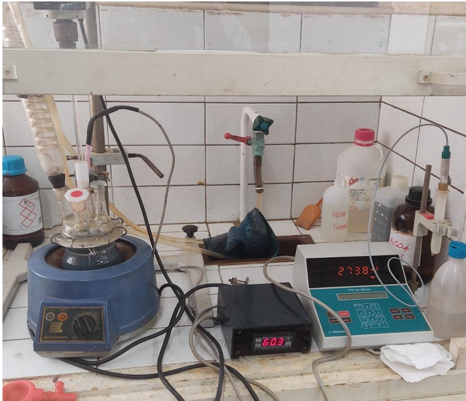
Εικόνα 6.16: Διάταξη με αντιδραστήρα εκχύλισης με θερμομανδύα (αριστερά) και συσκευή μέτρησης δυναμικού οξειδοαναγωγής (δεξιά)
