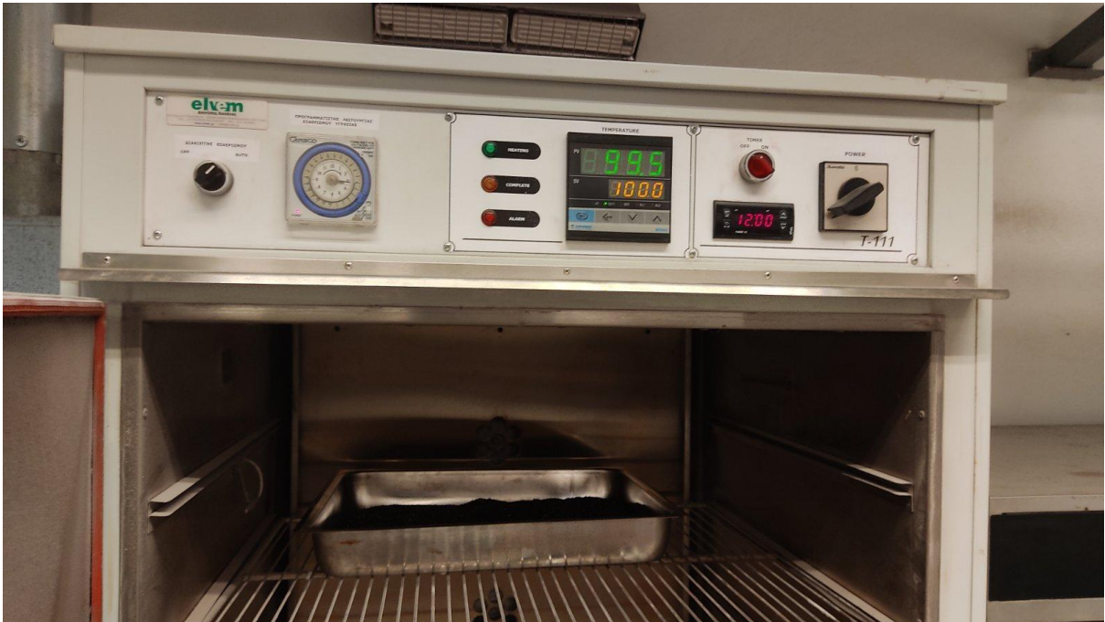
Εικόνα 6.6: Το υλικό λειοτριβήσης στον φούρνο στους 100 °C
