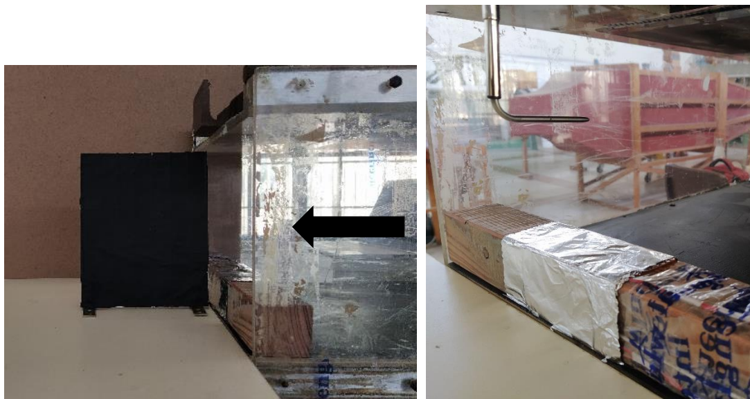
Εικόνα 14: Φωτογραφίες της διάταξης: α) διάταξη εμποδίου και φύλλου μέτρησης και β) εμπόδιο με τοποθετημένα τα θερμαντικά στοιχεία και το σωλήνα Pitot για τη μέτρησης της ταχύτητας, στην έξοδο της αεροσήραγγας
