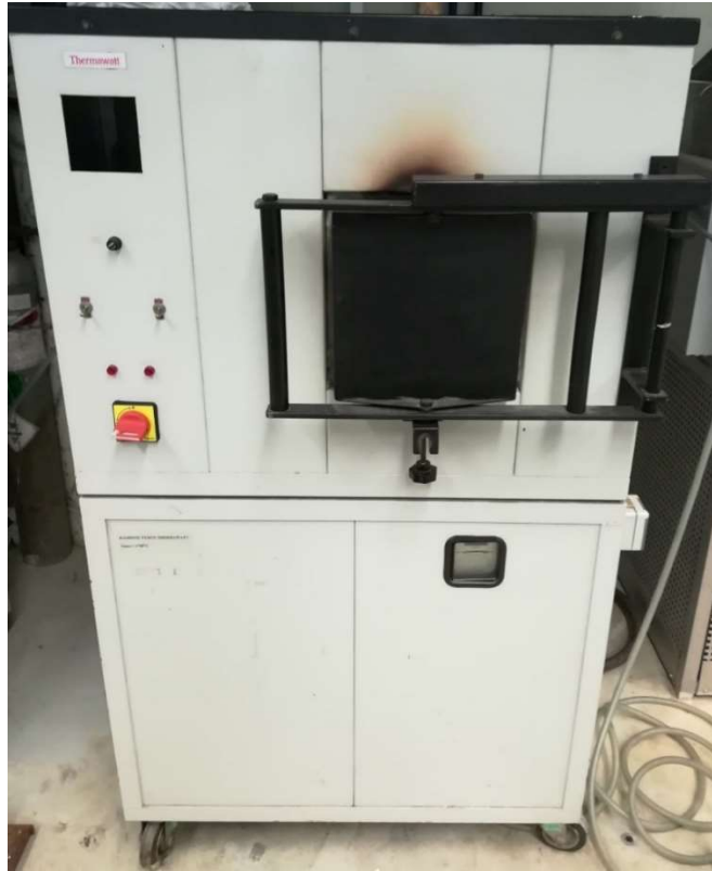
Εικόνα 5.1. Εργαστηριακή κάμινος THERMAWAT ηλεκτρικής αντίστασης Εργ. Μεταλλουργίας ΕΜΠ
