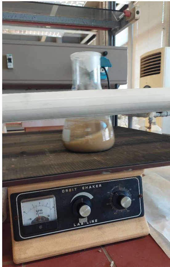
Εικόνα 5.4. Δοκιμή προκαταρκτικής εκχύλισης σε περιστροφικό αναδευτήρα
