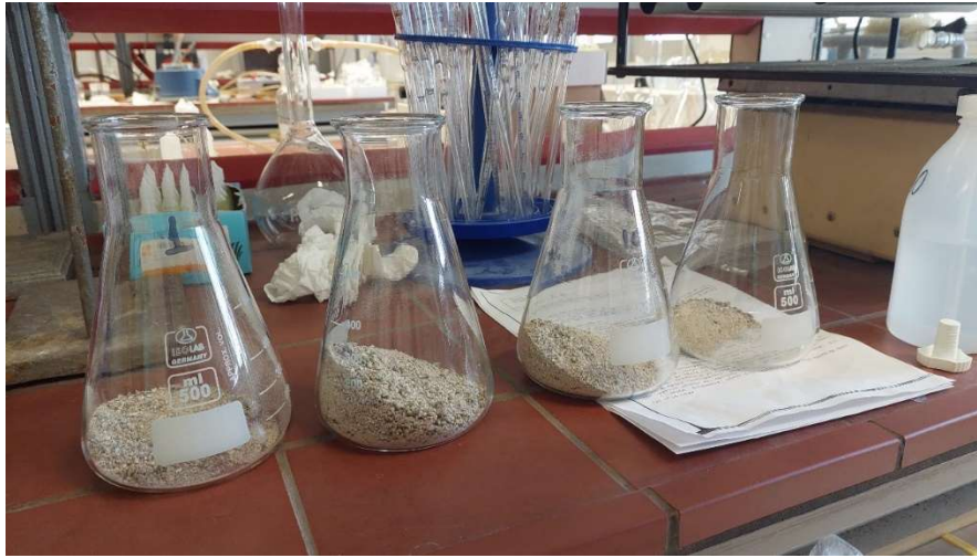
Εικόνα 5.2. Φρύγμα σε κωνικές φιάλες για τις προκαταρκτικές δοκιμές εκχύλισης
