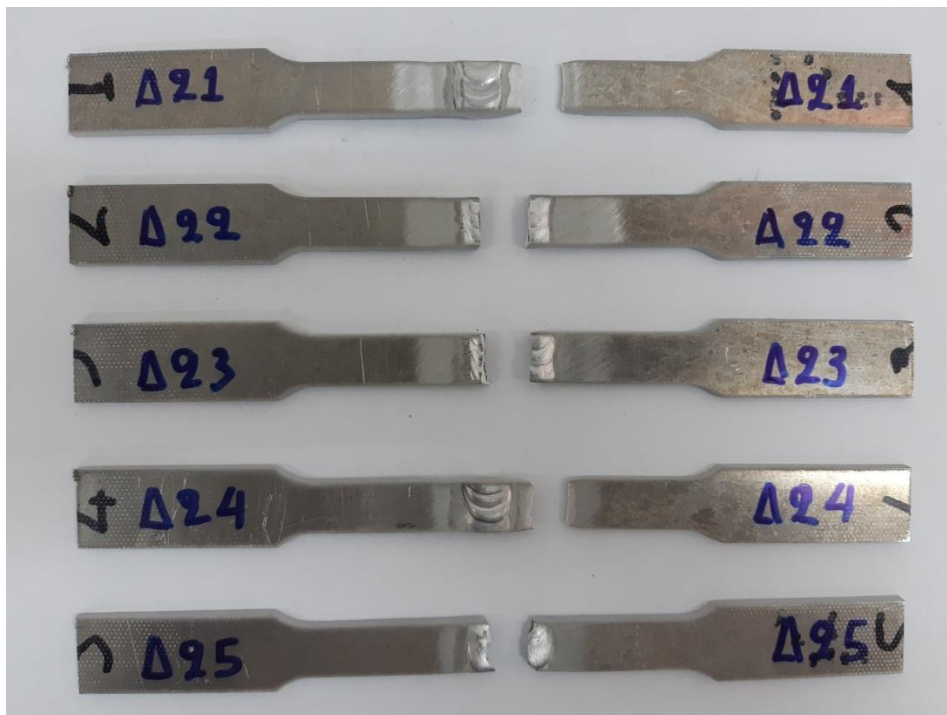
Εικόνα 35: Δοκίμια πλάκας Νο2 μετά τις δοκιμές σε εφελκυσμό
