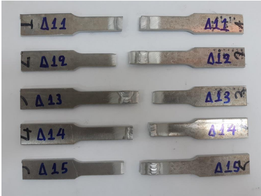
Εικόνα 32: Δοκίμια πλάκας Νο1 μετά τις δοκιμές σε εφελκυσμό
