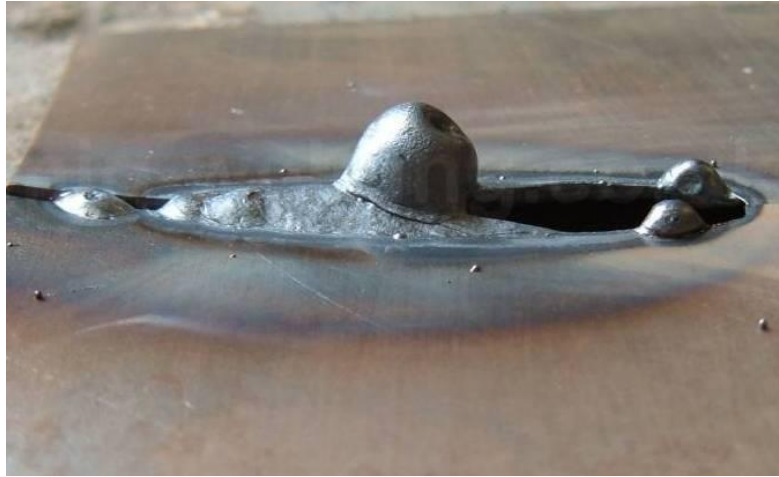
Εικόνα 11: Σφάλμα διαμπερούς τήξης
