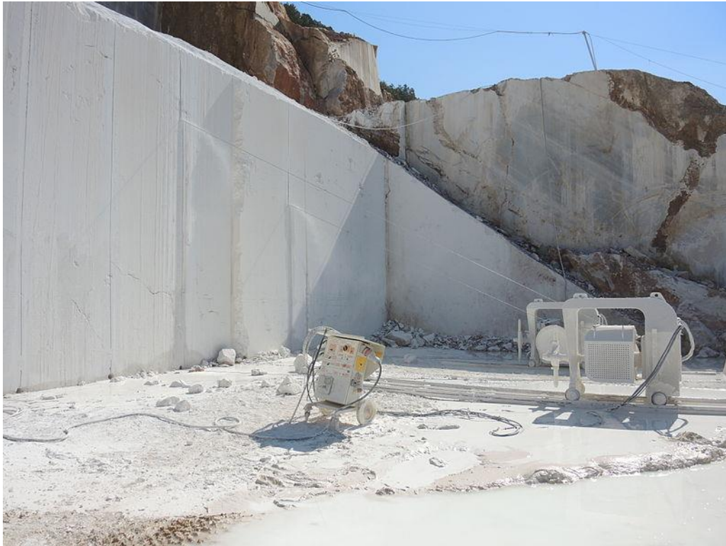
Εικόνα 4.3: Κοπή μαρμάρου με την χρήση αδαμαντοφόρου σύρματος (Πηγή: https://www.oryktosploutos.net/2015/02/blog-post_5-17/ 16/07/2022)
