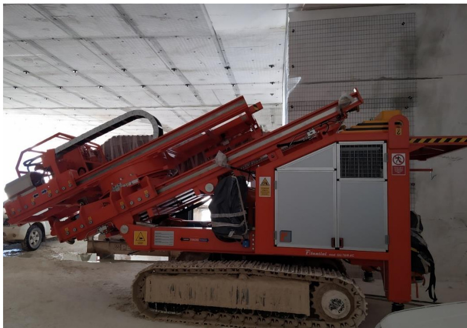
Εικόνα 4.5: Αλυσοπρίονο κοπής μαρμάρου σε υπόγεια εξόρυξη στο λατομείο Άριστον (Πηγή: Ίδιο αρχείο)
