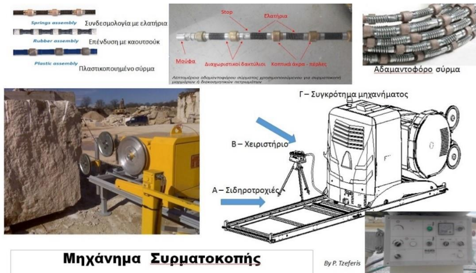
Εικόνα 4.2: Μονάδα συρματοκοπής (Πηγή: https://stonenews.eu/el/asfalia-michanimaton-syrmatokopis-i/ 20/01/2023)
