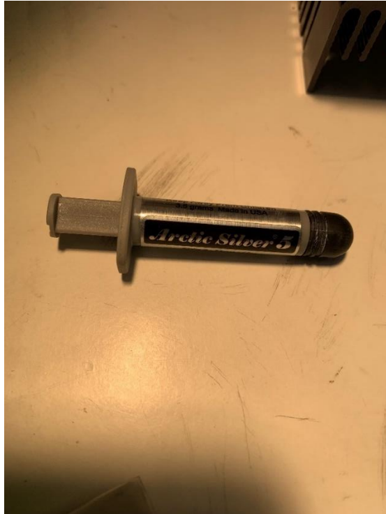
Σχήμα 5-3: Η θερμοαγώγιμη κόλλα (πάστα) που χρησιμοποιήθηκε
