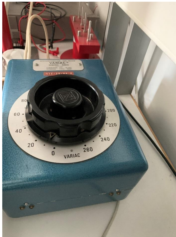
Σχήμα 5-18: Η γεννήτρια μέγιστης τάσης εξόδου 260V που χρησιμοποιήθηκε για το πείραμα
