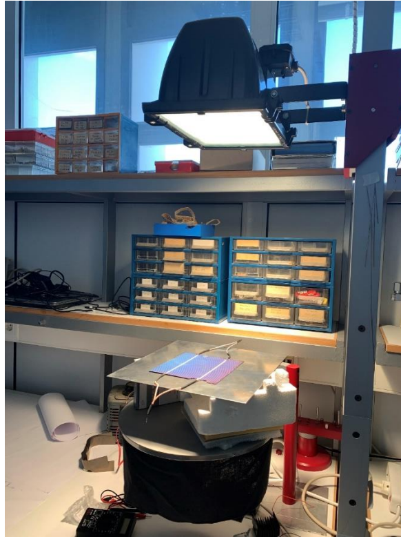
Σχήμα 5-15: Η διάταξη κάτω από τη δοκιμαστική διάταξη τεχνητού ήλιου
