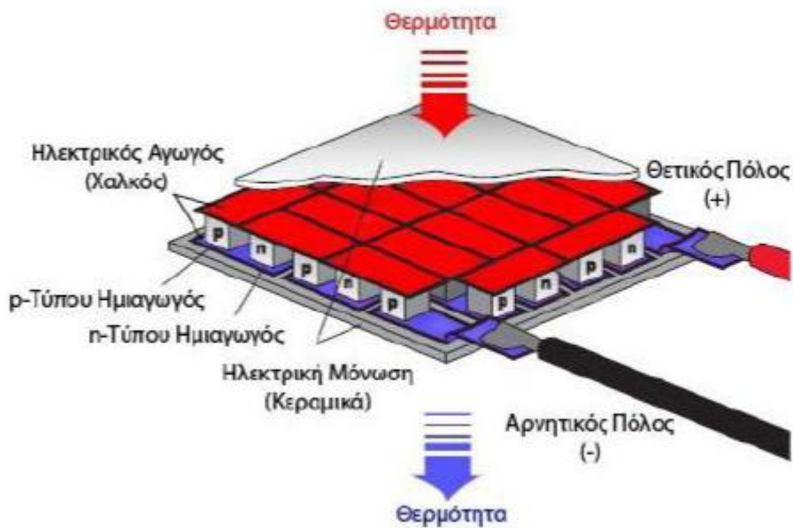
Σχήμα 3-7: Τομή θερμοηλεκτρικού στοιχείου Peltier [13].
