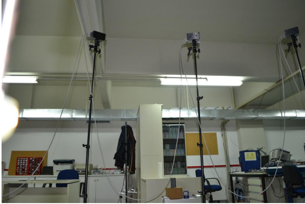
Σχήμα 13. Άποψη του τρόπου στησίματος των καμερών, όπως αυτή φαίνεται από την πλευρά του χώρου ενδιαφέροντος.
