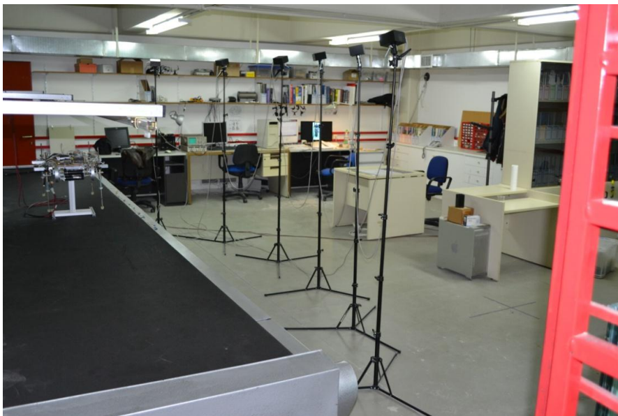
Σχήμα 15. Επίδειξη της ημικυκλικής μορφής τοποθέτησης των καμερών.
