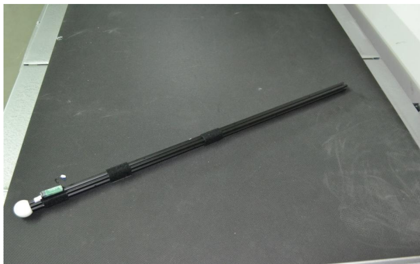
Σχήμα 17. Το calibration wand που χρησιμοποιείται για τη βαθμονόμηση του συστήματος.
