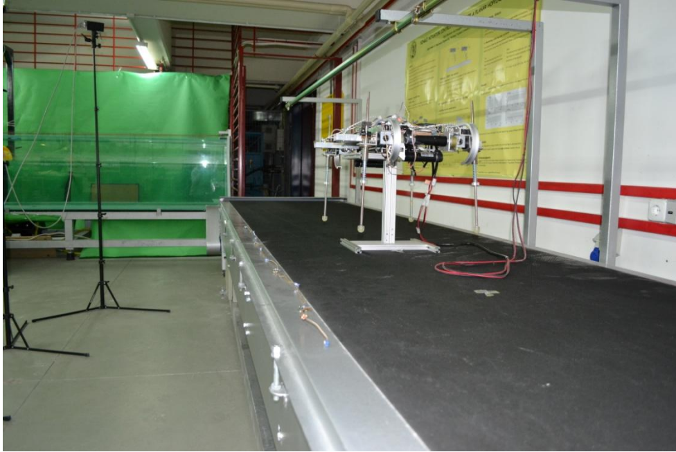
Σχήμα 18. Διάταξη στην οποία διακρίνονται τα LED (πορτοκαλί καλώδιο στο αριστερό πλευρό του διαδρόμου) που είναι τοποθετημένα κατά μήκος του κυλιόμενου διαδρόμου, έτσι ώστε να υπολογιστεί η γωνία ανάμεσα στο σύστημα συντεταγμένων του συστήματος των καμερών και στο σύστημα συντεταγμένων του τετράποδο ρομπότ.
