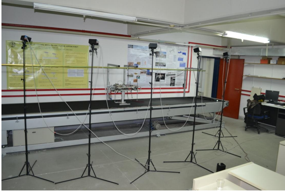
Σχήμα 12. Άποψη του τρόπου στησίματος των καμερών, όπως αυτή φαίνεται έξω από το χώρο ενδιαφέροντος.
