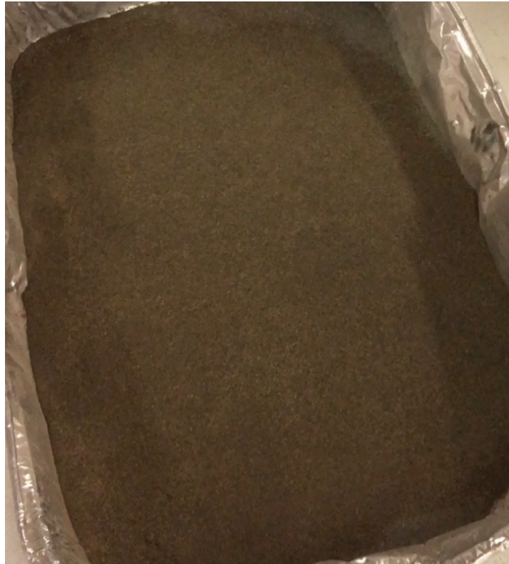
Εικόνα 8: Λεπτομερές κλάσμα σκόνης PCB (-0,6mm)
