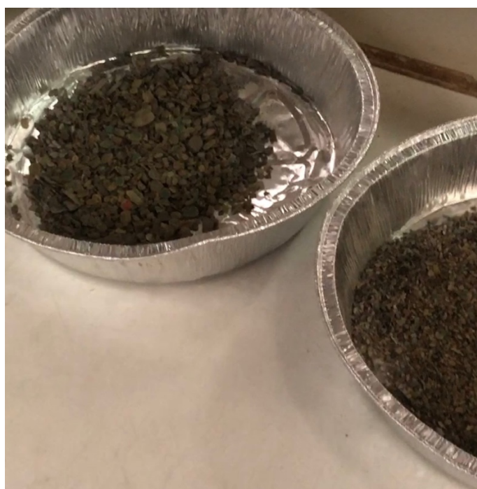
Εικόνα 7: Χονδρομερές κλάσμα σκόνης PCB (Αριστερά: +2mm , δεξιά: -2+1mm)
