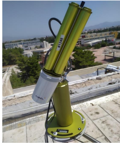
Εικόνα Ι.2. 2: Αριστερή εικόνα: ηλιακό φωτόμετρο CIMEL εγκατεστημένο στο Εθνικό Αστεροσκοπείο Αθηνών (Πηγή: https://react.space.noa.gr/component/content/article/40-equipment/148-cimel-sunphotometer-5.html?Itemid=101 ). Δεξιά εικόνα: ηλιακό φωτόμετρο CIMEL εγκατεστημένο στο Εθνικό Μετσόβιο Πολυτεχνείο.
