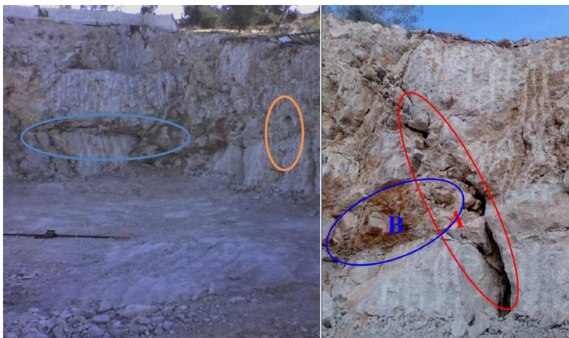
Εικόνα 5.8 : Δολομιτικοί σχηματισμοί στο λιμάνι της Πάχης, εμφανή ρήγματα μερικά πληρωμένα με αργιλικό υλικό.
