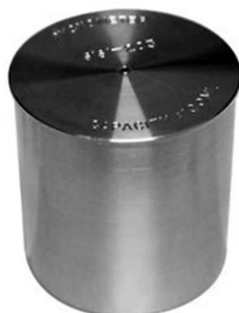
Εικόνα 17: Πυκνόμετρο, το σκεύος που χρησιμοποιείται για την μέτρηση του ειδικού βάρους.
