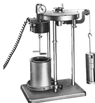
Εικόνα 16: Ιξωδόμετρο τύπου Stormer.
