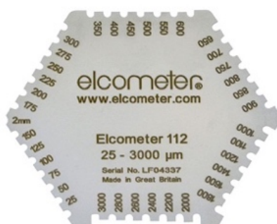
Εικόνα 20: Μετρητής πάχους υγρού υμενίου 112AL της εταιρείας Elcometer.
