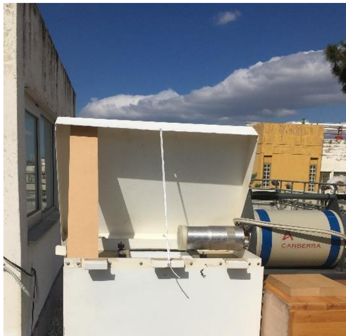
ΕΙΚΟΝΑ 3. 8: Πλάγια όψη της διάταξη BEGe και δειγματολήπτη μεγάλου όγκου αέρα.
