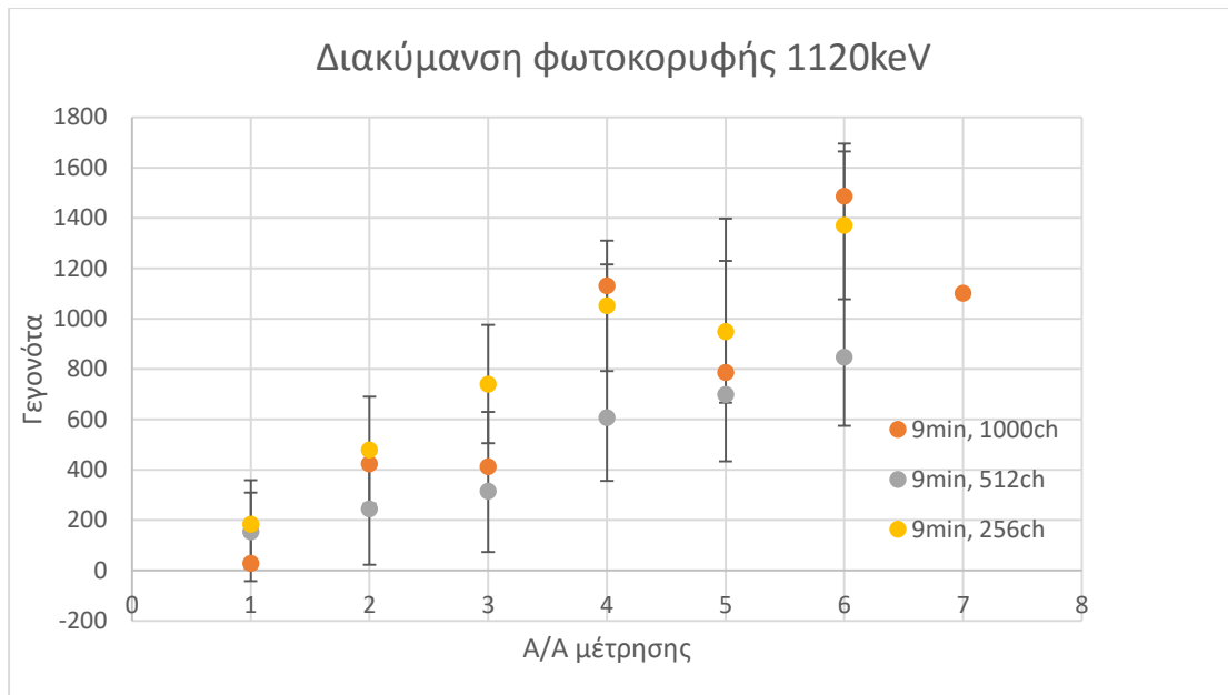
ΔΙΑΓΡΑΜΜΑ 4. 9: Εξέλιξη του ^{214}\text{Bi} βάσει της φωτοκορυφής 1120 keV για τις διαφορετικές ρυθμίσεις του ADC.
