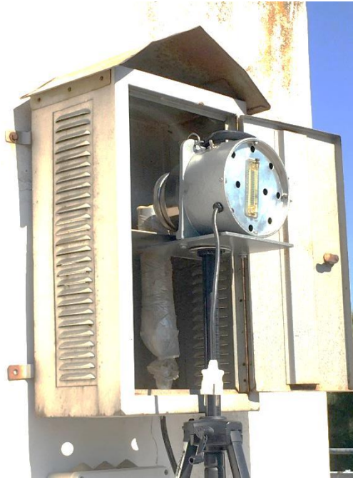
ΕΙΚΟΝΑ 3. 4: Διάταξη αντλίας μικρής παροχής και ανιχνευτή NaI 2"x2"
