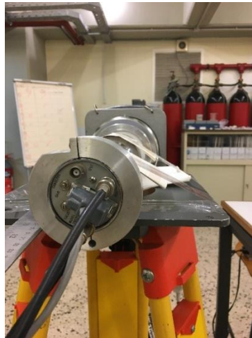
ΕΙΚΟΝΑ 3. 2: Πρόσωση της διάταξης και απεικόνιση της εξόδου του φωτοπολλαπλασιαστή
