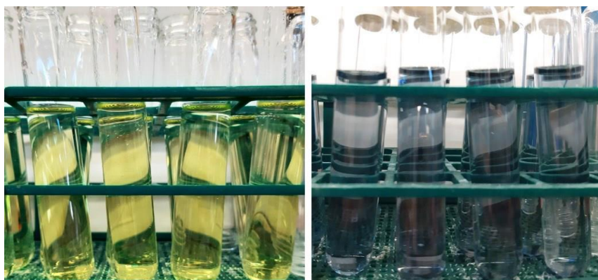
Εικόνα 18: Διαλύματα πριν (αριστερά) και μετά (δεξιά) την οξείδωση των φαινολικών ενώσεων με το αντιδραστήριο Folin-Ciocalteu.
