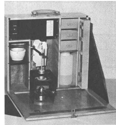
Σχήμα 7.2. Συσκευή μέτρησης της θερμότητας διαβροχής
