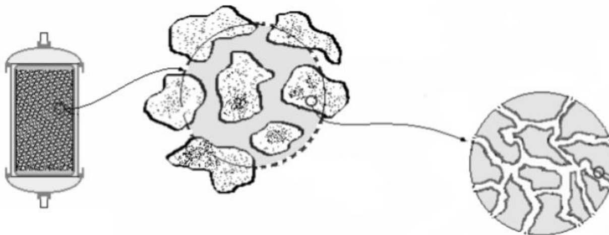
Σχήμα 3.20. Πορώδες σωματίδια σε κλίση - απεικόνιση διασωματειακού κενού σωματιδίων, και εσωτερικών κενών σωματιδίου (π.χ. κανάλια) (Borges da Silva et al., 2007).
