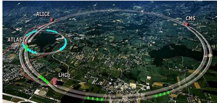
Σχήμα 2.1: Ο δακτύλιος του επιταχυντή LHC με τα τέσσερα πειράματα ATLAS, CMS, ALICE και LHCb.
