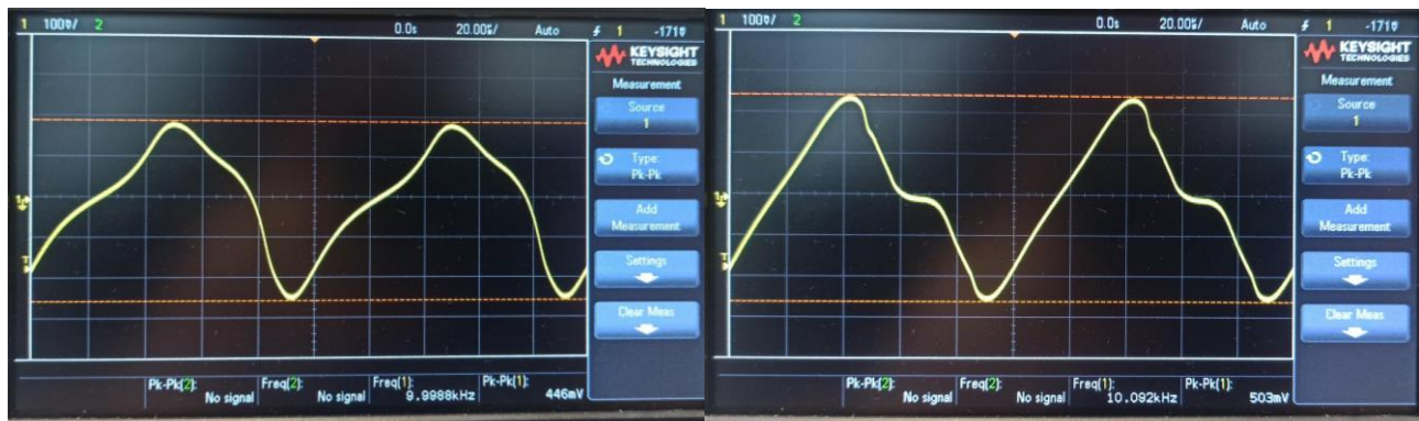
Σχήμα 4.7 Το σήμα λήψης, όπως φαίνεται στην οθόνη του παλμογράφου, για σήμα διέγερσης πλάτους 5V και συχνότητας f=10 kHz. Αριστερά: χωρίς την επίδραση του ηλεκτρομαγνήτη, Δεξιά: Υπό την επίδραση του ηλεκτρομαγνήτη.
