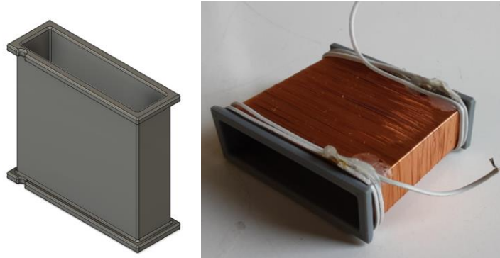
Σχήμα 4.15 Αριστερά: το ψηφιακό μοντέλο όπου τυπώθηκε για την κατασκευή του πηνίου λήψης, Δεξιά: Το εκτυπωμένο πλαίσιο, τυλιγμένο με το πηνίο λήψης.
