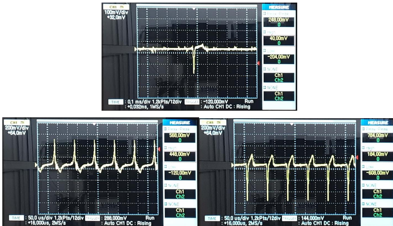
Σχήμα 4.28 Το σήμα λήψης, όπως φαίνεται στην οθόνη του παλμογράφου, σε διάφορα στιγμιότυπα της μέτρησης με σήμα διέγερσης πλάτους πλάτους 17 V.
