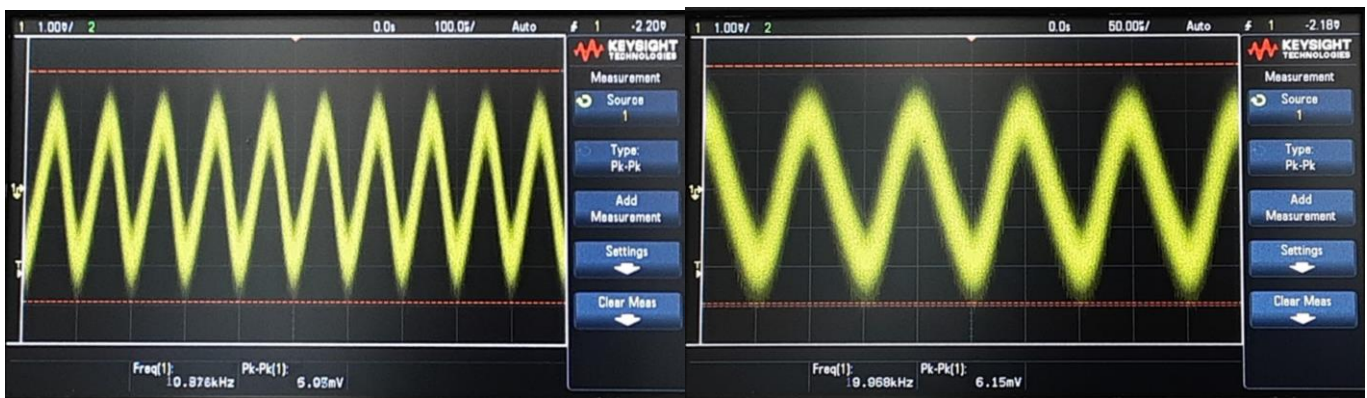
Σχήμα 4.11 Το σήμα λήψης, όπως φαίνεται στην οθόνη του παλμογράφου, για σήμα διέγερσης πλάτους 5V και συχνότητα f=10 kHz. Αριστερά: χωρίς την επίδραση του ηλεκτρομαγνήτη, Δεξιά: Υπό την επίδραση του ηλεκτρομαγνήτη.
