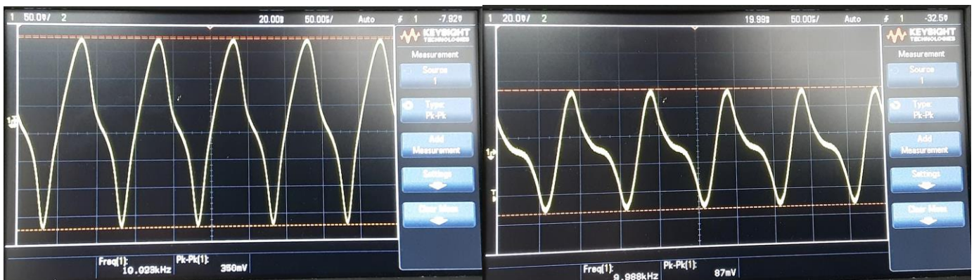
Σχήμα 4.9 Το σήμα λήψης, όπως φαίνεται στην οθόνη του παλμογράφου, για σήμα διέγερσης πλάτους 5V και συχνότητα f=10 kHz. Αριστερά: χωρίς την επίδραση του ηλεκτρομαγνήτη, Δεξιά: Υπό την επίδραση του ηλεκτρομαγνήτη.
