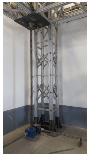
Εικόνα 132 Πυλώνας εκτυπωτή Σχεδιασμός - Κατασκευή
