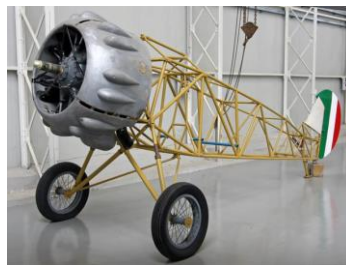
Εικόνα 30 Το δικτύωμα Warren στην κατασκευή της ατράκτου ενός συμβατικού αεροπλάνου του 1ου Π.Π.
