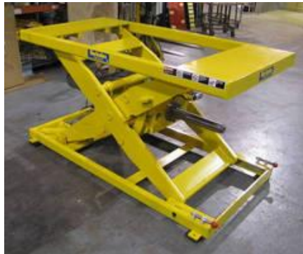
Εικόνα 67 Ψαλιδωτός μηχανισμός με χρήση μεταφορικού κοχλία
