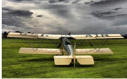
Εικόνα 29 Δικτύωμα Warren σε διπλάνο. Δεν επέτρεπε την στρέψη των πτερύγων
