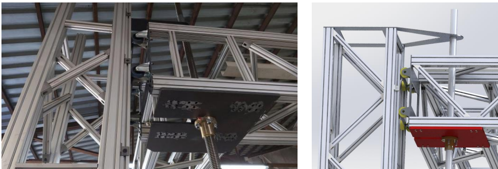
Εικόνα 133 Εκτυπωτής με ροδάκια αντί για βαγόνια (Κατασκευή - Μοντέλο)
