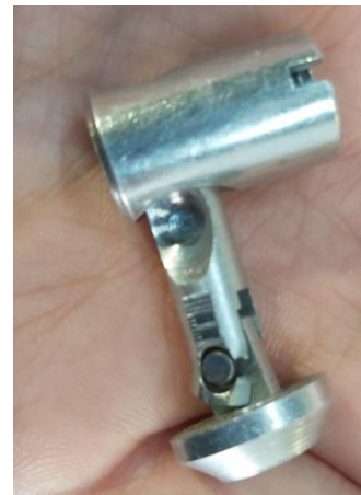
Εικόνα 40 Συνδετικό μέσο που αστόχησε (Mitre-Fastening Set 8)
