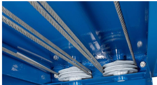
Εικόνα 68 Ψαλιδωτός μηχανισμός με χρήση συρματόσχοινων
