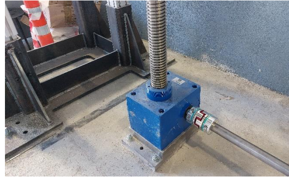
Εικόνα 130 Μηχανισμός ανύψωσης Σχεδιασμός - Κατασκευή
