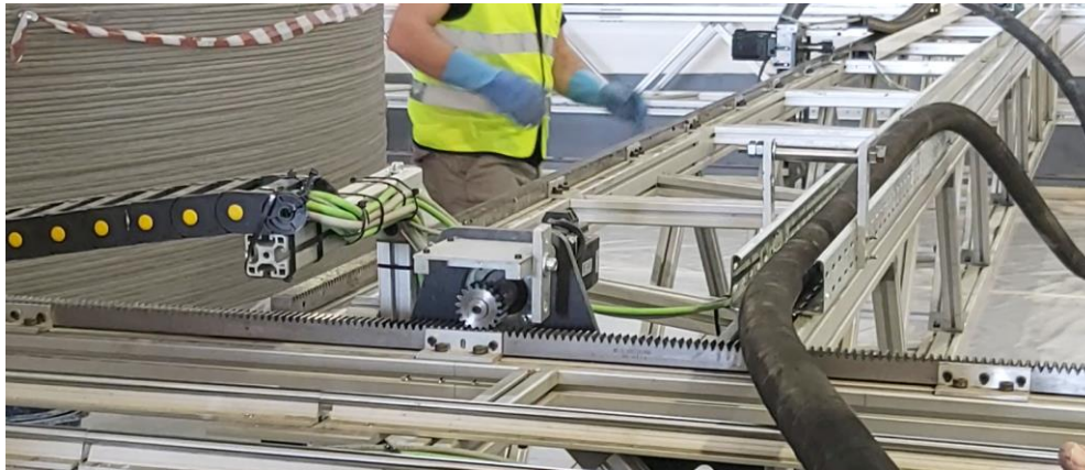
Εικόνα 127 Οδοντωτός κανόνας - πινιόν (Κατασκευασμένος εκτυπωτής)
