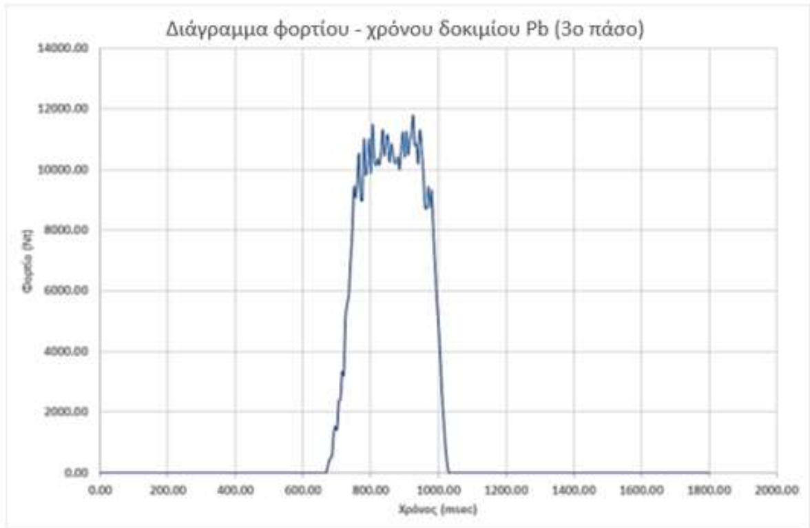
Διάγραμμα 13 Διάγραμμα φορτίου – χρόνου της προσομοίωσης για το δοκίμιο του μολύβδου στο 3 ο πάσο
