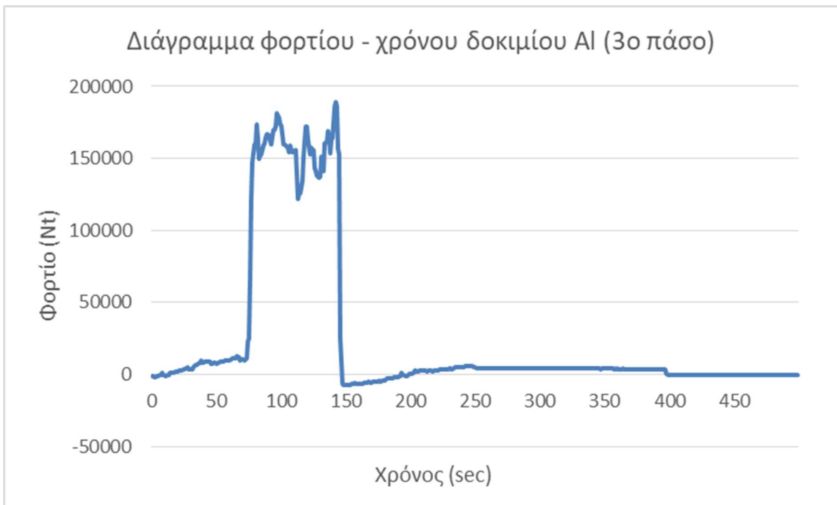
Διάγραμμα 7 Διάγραμμα φορτίου – χρόνου για το δοκίμιο του ΑΙ μετά το 3ο πάσο
