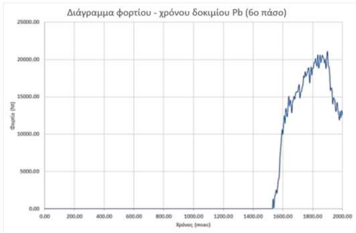
Διάγραμμα 16 Διάγραμμα φορτίου – χρόνου της προσομοίωσης για το δοκίμιο του μολύβδου στο 6 ο πάσο
