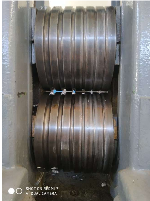
Εικόνα 31 Διάταξη των τυμπάνων της μηχανολογικής διάταξης με εμφανείς τις κυλινδρικές αυλακώσεις
