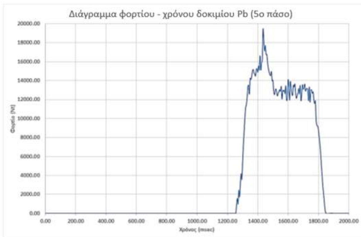
Διάγραμμα 15 Διάγραμμα φορτίου – χρόνου της προσομοίωσης για το δοκίμιο του μολύβδου στο 5 ο πάσο
