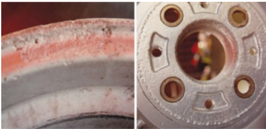
Σχήμα 3.4: Διάβρωση σε τροχούς μαγνησίου
