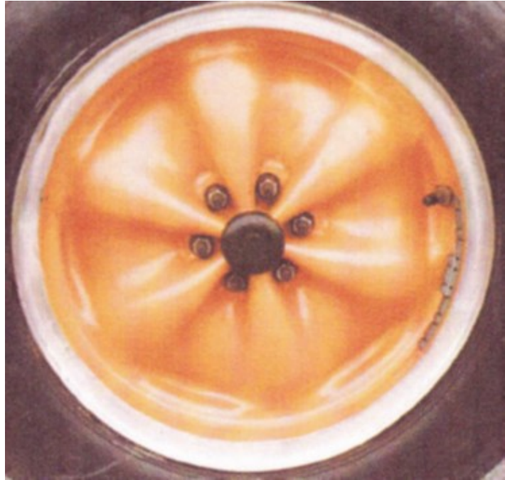
Σχήμα 3.3: Τροχός μαγνησίου για αγωνιστικά αυτοκίνητα Lotus F1 του 1958 (μέγεθος 5 J 15, βάρος 3,7 kg!)
