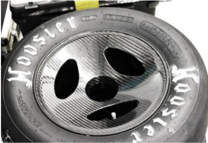
Σχήμα 3.12: Μονοκόμματη FSAE ζάντα ανθρακόνημα. Δεν χρησιμοποιούνται μεταλλικά ένθετα. Μόνο η βαλβίδα δεν είναι κατασκευασμένη από σύνθετο υλικό
