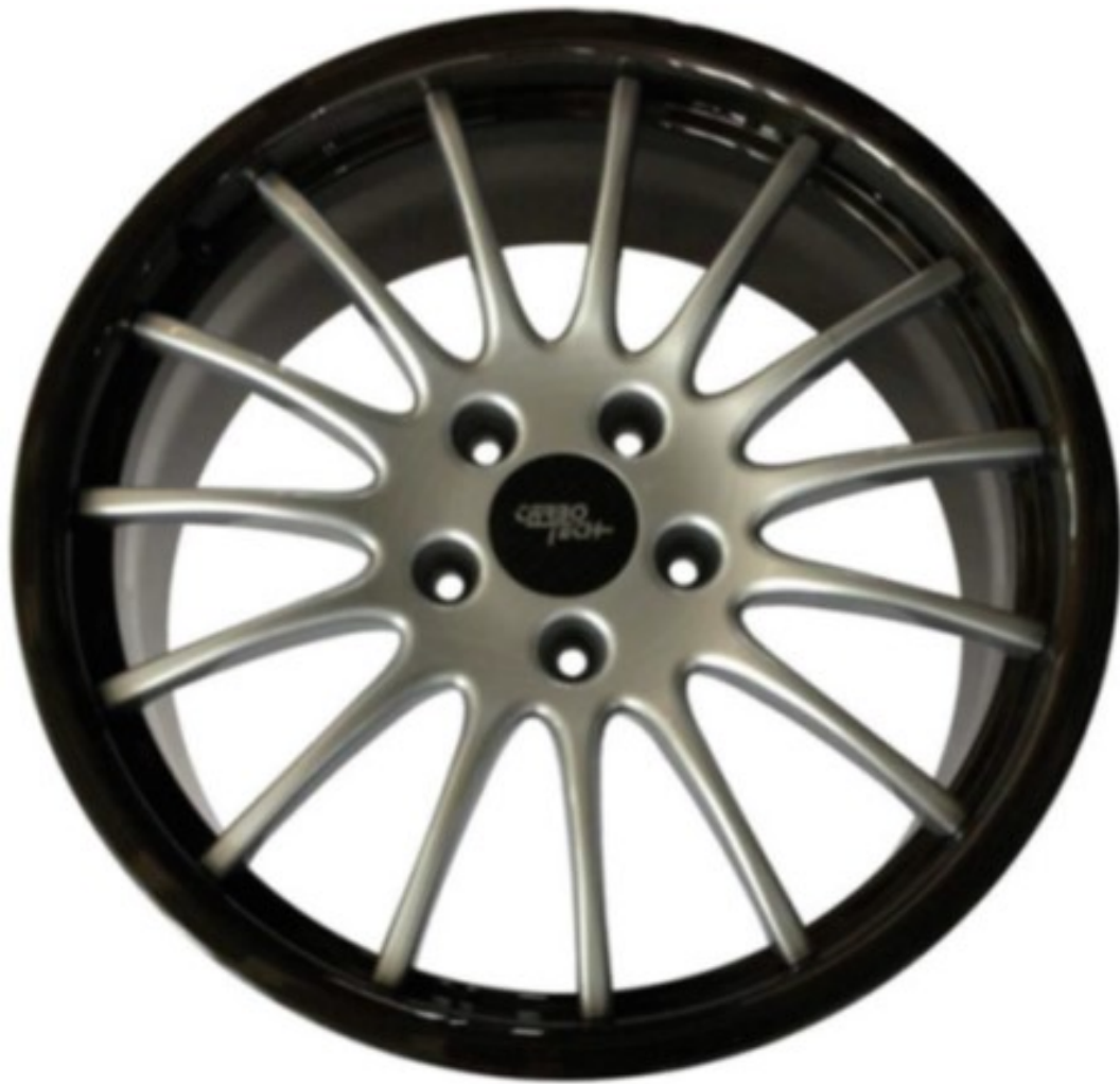
Σχήμα 3.9: Υβριδική Ζάντα Αλουμινίου-ανθρακονήματος
