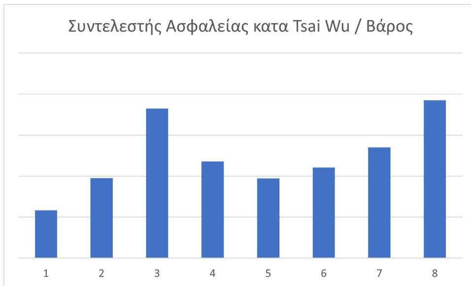
Σχήμα 11.52: Συντελεστής Ασφαλείας κατά Tsai Wu / Βάρος για τις διαστρωματώσεις
