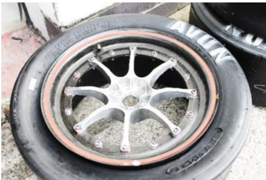
Σχήμα 3.13: Υβριδική FSAE ζάντα με κέντρο αλουμινίου και διαιρούμενες στεφάνες από ανθρακονήματα. Η συναρμολόγηση γίνεται με κόλλα και κοχλιοσύνδεση.
