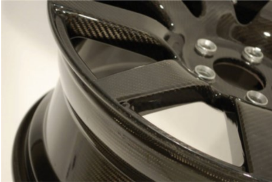
Σχήμα 3.8: Ζάντα από ανθρακόνημα με μεταλλικά ένθετα
