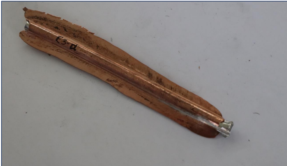
Εικόνα 26: Αστοχία δοκιμίου E3-a 2 ου Πειράματος
