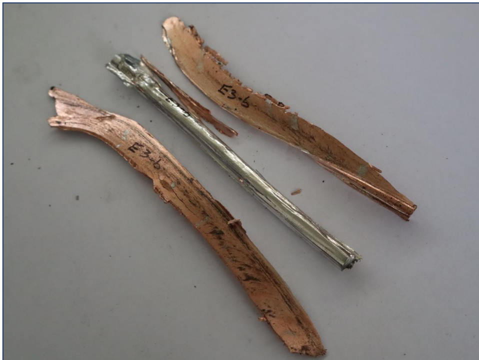
Εικόνα 28: Αστοχία δοκιμίου E3-b 2 ου Πειράματος
