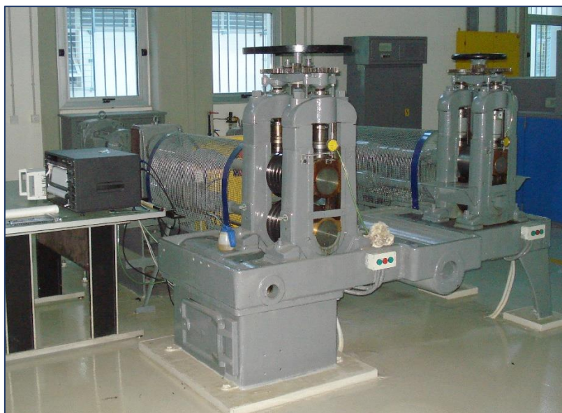
Εικόνα 7: Έλαστρο εργαστηρίου τεχνολογίας κατεργασιών στο οποίο έγιναν οι πειραματικές δοκιμές [13]
