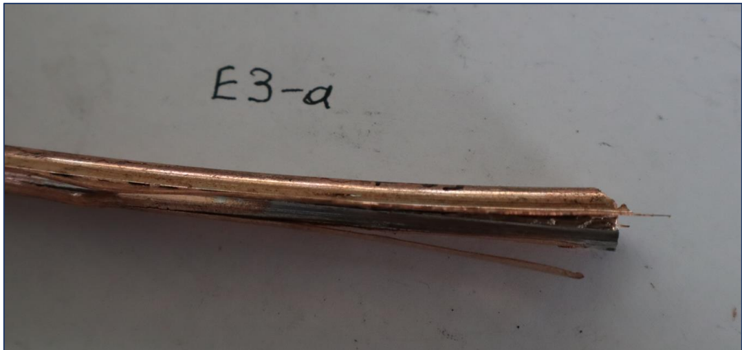
Εικόνα 27: Αστοχία δοκιμίου E3-a 2 ου Πειράματος
