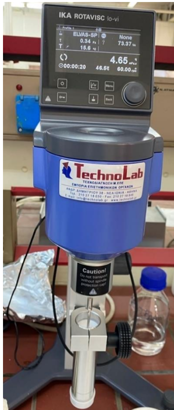
Εικόνα 50: Περιστρεφόμενο ιξωδόμετρο τύπου Brookfield του εργαστηρίου κατά τη διάρκεια μέτρησης
