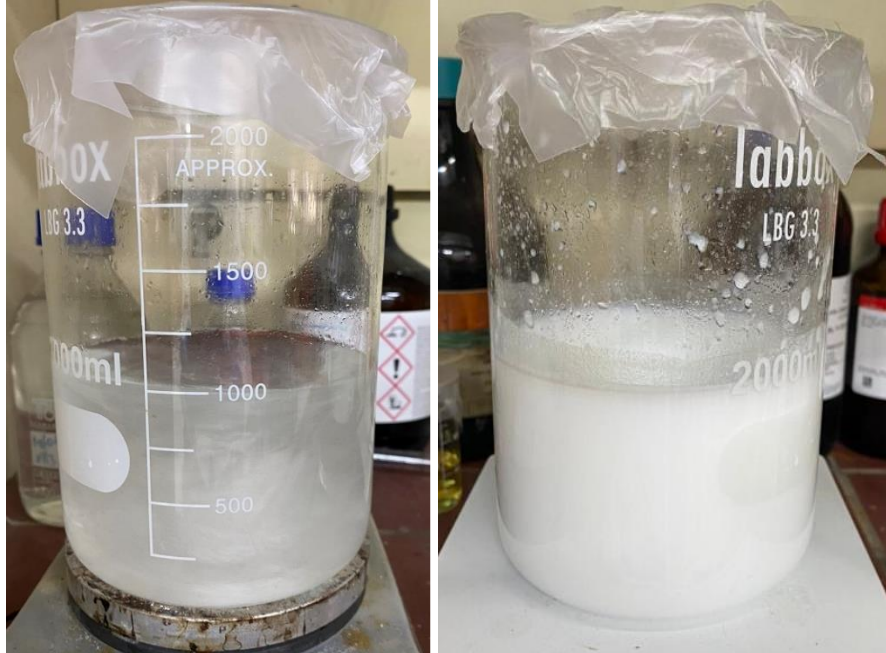
Εικόνα 38: Ανάδευση νιτρικών αλάτων ζιρκονίας [Zr(NO_3)_2] και ύττριας [Y(NO_3)_3] σε απιονισμένο νερό με μαγνητικό αναδευτήρα πριν και μετά την προσθήκη αμμωνίας ( NH_3 )
