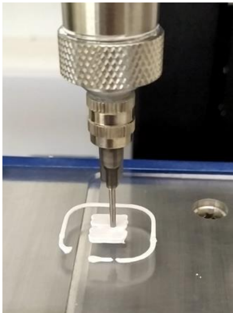
Εικόνα 66: Εκτύπωση πάστας με τη μέθοδο robocasting
