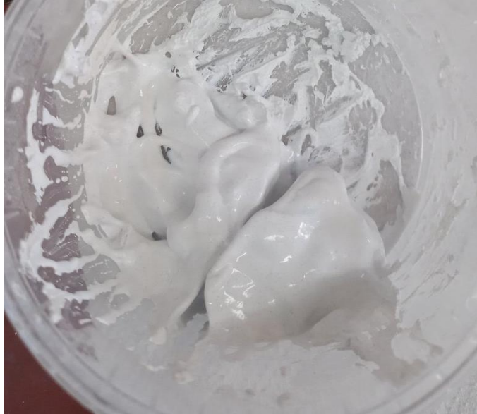
Εικόνα 65: Πάστα προς εκτύπωση ( ZrO_23Y-O2 ) με 56,5% ποσοστό στερεών και πρόσθετα 1% Dolarix CE64 0.1%, ACR και 0.01% NN
