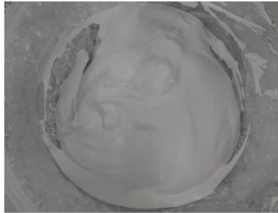
Εικόνα 61: Πάστες με ίδιο ποσοστό στερεών αλλά με διαφορετικό τρόπο ανάμειξης των υλικών
