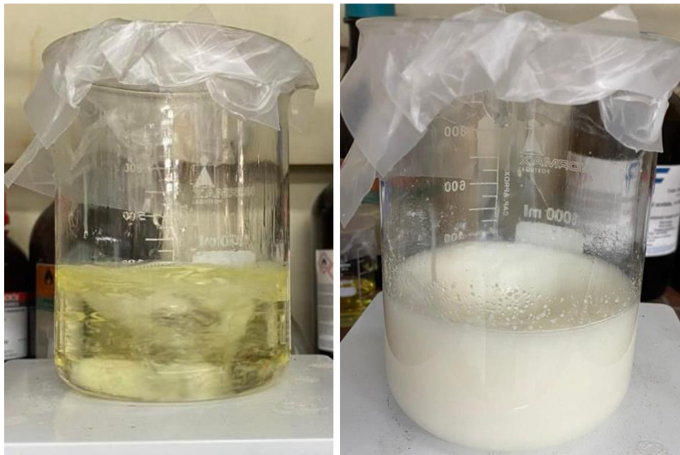
Εικόνα 40: Ανάδευση προπανόλης ( C_3H_8O ), ύττριας [ Y(NO_3)_3 ] και οργανικού πρόδρομου ζirkονίου με μαγνητικό αναδευτήρα πριν και μετά την προσθήκη αμμωνίας ( NH_3 )
