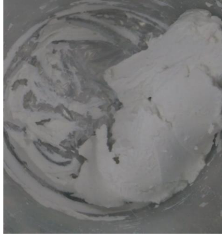
Εικόνα 59: Πάστα 50% με πρόσθετα 1% Dolarix, 0.1% ACR και 0.01% NN
