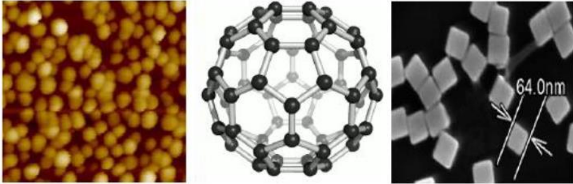
Εικόνα 2: Νανοσωματίδια χρυσού (αριστερά), ανθρακική δομή- φουλερένιο (μέση), τετραγωνικά νανοσωματίδια αργήρου (δεξιά)
