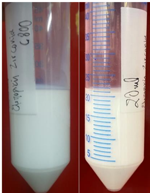
Εικόνα 51: Αιώρημα ζιρκονίας (Z3Y-C800) την 1η και την 18η μέρα εναπόθεσης του στο φάλλον
