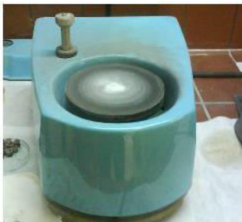
Εικόνα 4.5: Τροχός λείανσης περιστρεφόμενης βάσης με βελούδινη επιφάνεια
