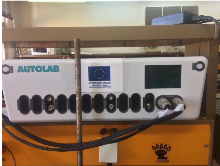
Εικόνα 4.4: Ποτενσιοστάτης Metrohm Autolab PGSTAT302N
