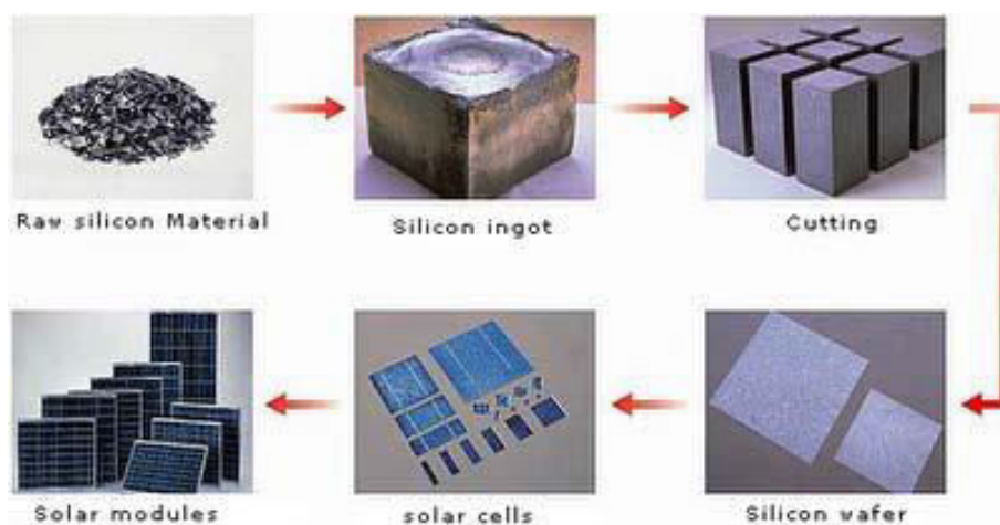
Εικόνα 2.2: Διάγραμμα κατασκευής φωτοβολταϊκού, http://solarphotovoltaic.blogspot.com/
