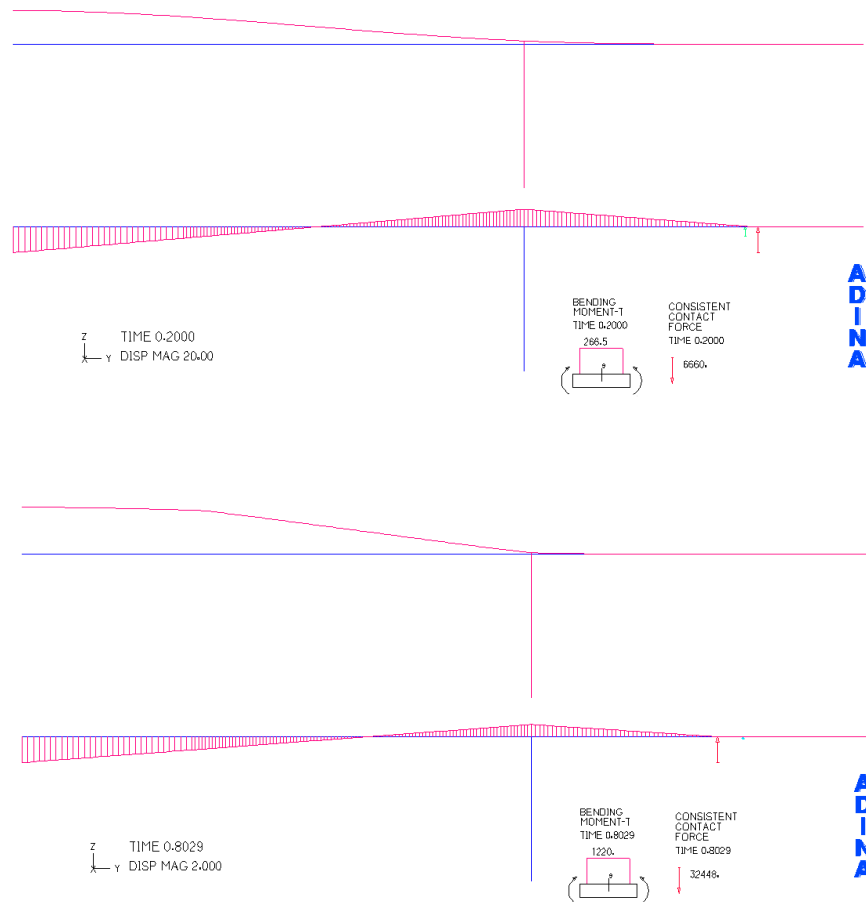
Σχήμα 3-39. Παραμορφωμένη γεωμετρία (σε μεγέθυνση) και διάγραμμα ροπών κάμψης και δυνάμεων επαφής στο πέλμα σε αρχικό στάδιο της φόρτισης (άνω) και σε τελικό στάδιο (κάτω)
