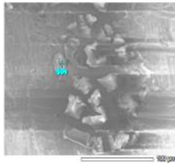
Σχήμα 4: Ανάλυση EDS στο ηλεκτροαποτιθέμενο αλουμίνιο σε: α) κάθοδο υαλώδη άνθρακα (GC), β) κάθοδο σιδήρου, γ) κάθοδο χαλκού [5]
