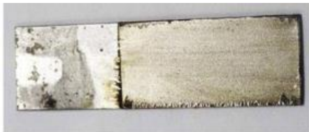
Σχήμα 10: Φωτογραφία στρώματος νικελίου που εναποτίθεται σε υπόστρωμα από μαλακό χάλυβα, και μετέπειτα δέχεται ηλεκτρόλυση από διάλυμα αιθαλίνης ( \text{ChCl}: 2 \text{ EG} ) που περιέχουν 1,14 \text{ mol dm}^{-3} στους 80^\circ \text{C} και πυκνότητα ρεύματος 1,5 \text{ Adm}^{-3} για 1 ώρα
