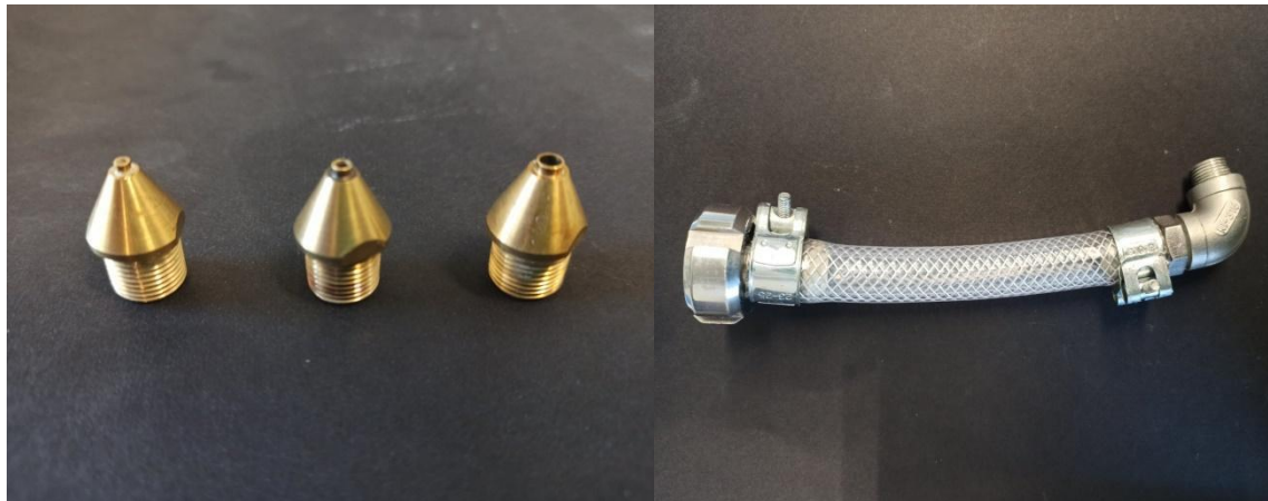
Σχήμα 46: (α) Ακροφύσια διαμέτρων 1.5, 2 και 3 mm και (β) σωλήνας που συνδέει την δεξαμενή αποθήκευσης πάστας με τον εξωθητή
