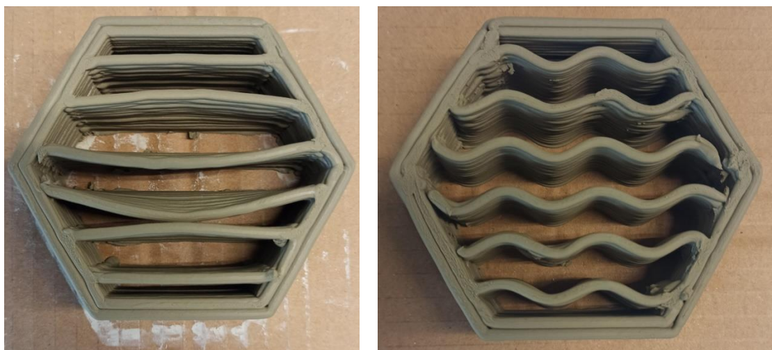
Σχήμα 52: Εκτυπωμένα δοκίμια Ζεόλιθου με extrusion multiplier 2
