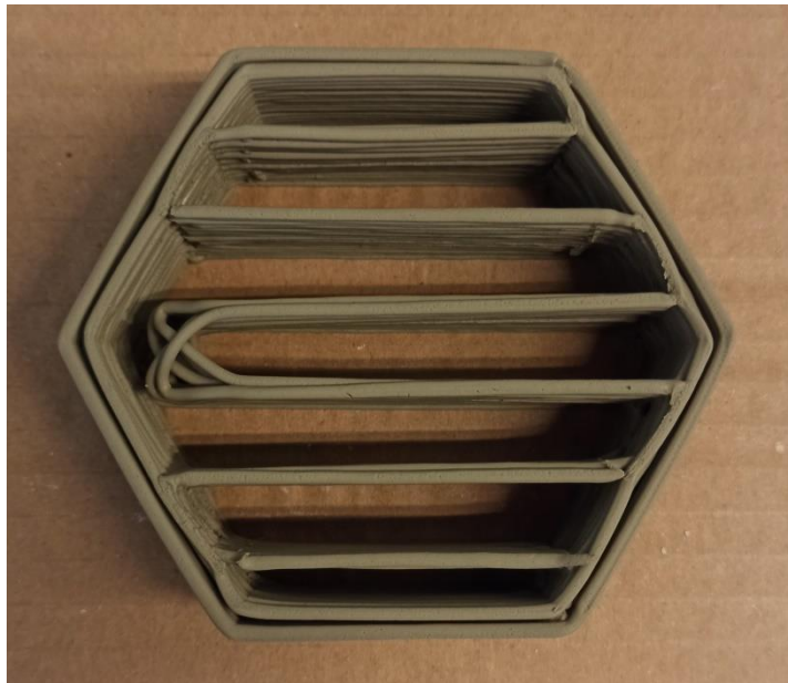
Σχήμα 50: Εκτυπωμένο δοκίμιο Ζεόλιθου με extrusion multiplier 1
