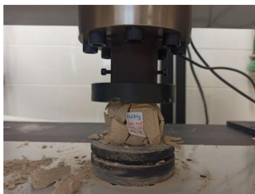
Σχήμα 54: Κυβικό δοκίμιο (α) πριν και (β) μετά από μονοαξονική θλίψη
