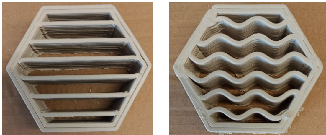
Σχήμα 51: Εκτυπωμένα δοκίμια Καολίνη με extrusion multiplier 2
