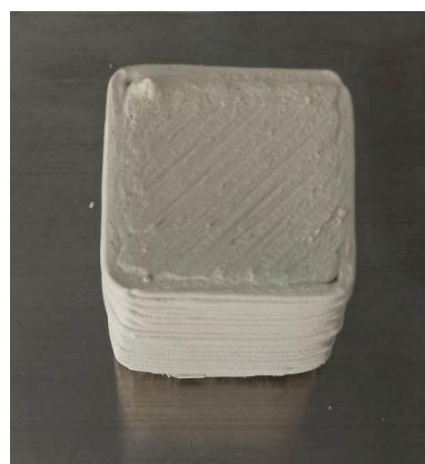
Σχήμα 53: Σχεδιασμένο (α) και εκτυπωμένο (β) κυβικό δοκίμιο διαστάσεων 50mm
