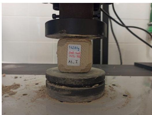
Σχήμα 54: Κυβικό δοκίμιο (α) πριν και (β) μετά από μονοαξονική θλίψη
