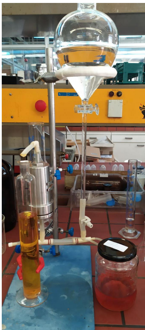
Εικόνα 4.4 Πειραματική διάταξη εξαντλητικής εκχύλισης σταθερής κλίσης σε παραπροϊόν τσίπουρο τομάτας για παραλαβή καροτενοειδών, με διαλύτη οξικό αιθυλεστέρα.
