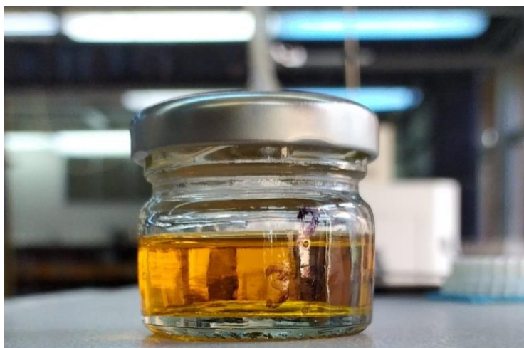
Εικόνα 5.4 Γυάλινο βαζάκι με εκχύλισμα τσίπουρου τομάτας σε διαλύτη οξικό αιθυλεστέρα μετά τη διήθηση του με φίλτρο για τον διαχωρισμό από τη στερεά μήτρα.
