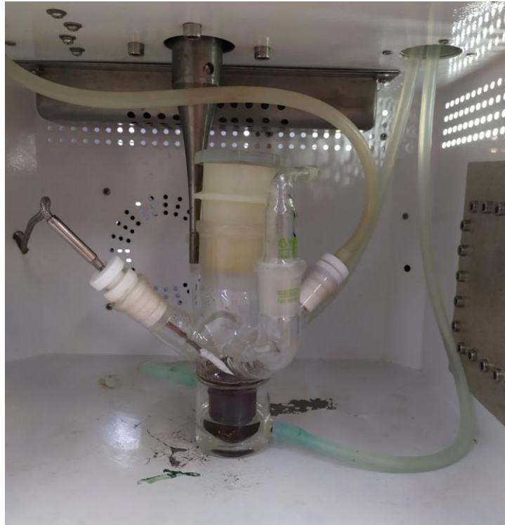
Εικόνα 4.3 Δοχείο εκχύλισης με ελαιοπυρήνα και διαλύτη μέσα στο θάλαμο εκχύλισης με μικροκύματα. Διακρίνονται τα πράσινα σωληνάκια κυκλοφορίας του ψυκτικού υγρού, το θερμόμετρο (αριστερά), ο σωλήνας προς τον εξωτερικό ψυκτήρα για ανακύκλωση του εξατμιζόμενου διαλύτη (δεξιά), οι τάπες στα υπόλοιπα στόμια του δοχείου και το μεταλλικό στέλεχος των υπερήχων το οποίο διαθέτει η συσκευή, που ωστόσο δε χρησιμοποιήθηκε στα πειράματα τις παρούσας διπλωματικής εργασίας.
