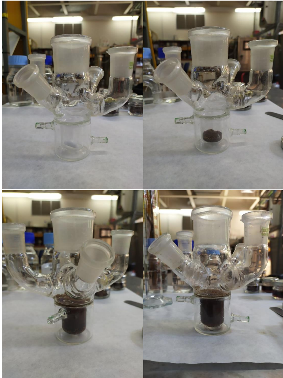
Εικόνα 4.2 Δοχείο εκχύλισης (beaker) άδειο (πάνω αριστερά), με στερεή πρώτη ύλη αλεσμένο ελαιοπυρήνα (πάνω δεξιά), με ελαιοπυρήνα και διαλύτη πριν την εκχύλιση (κάτω αριστερά), με ελαιοπυρήνα και διαλύτη μετά την εκχύλιση (κάτω δεξιά).
