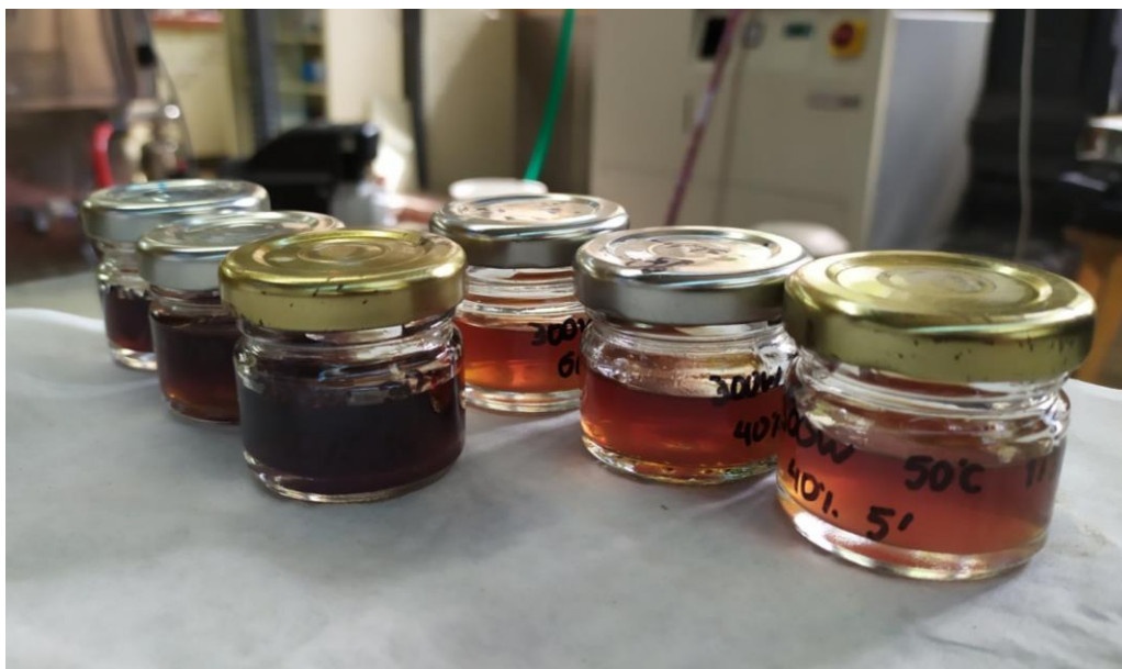
Εικόνα 5.1 Εκχυλίσματα ελαιοπυρήνα σε αναλογία στερεού : υγρού 1:10 g/mL (αριστερά) και 1:30 g/mL (δεξιά) μετά από τη εκχύλιση με ΜΑΕ.
