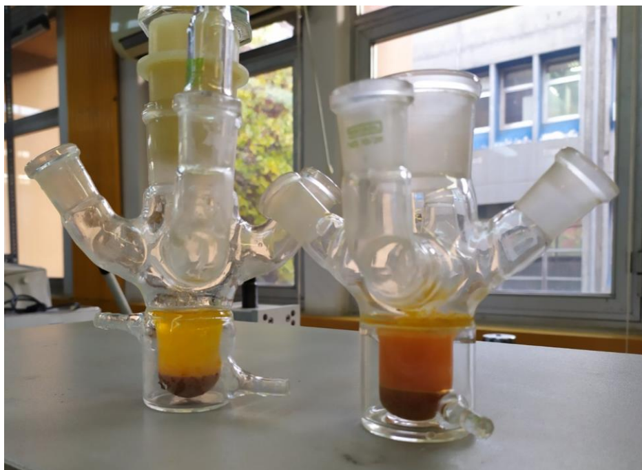
Εικόνα 5.3 Δοχείο εκχύλισης με δείγμα στερεού τσίπουρου τομάτας και διαλύτη οξικού αιθυλεστέρα πριν την εκχύλιση MAE (αριστερά) και μετά την εκχύλιση MAE (δεξιά).
