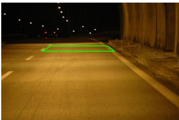
Εικόνα 8.24 : Παράδειγμα του τελικού τραπέζιου στο οποίο θα γίνουν μετά οι υπολογισμοί για τη μέτρηση της λαμπρότητας.
