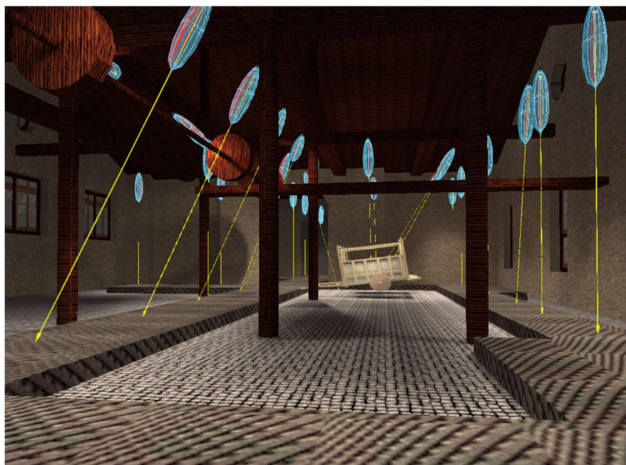
Εικόνα 107: Προσομοίωση φωτισμού χώρου Μουσείου στο περιβάλλον Dialux, που απεικονίζει τις στρέψεις των φωτιστικών προς τα εκθέματα και προς τον διάδρομο.
