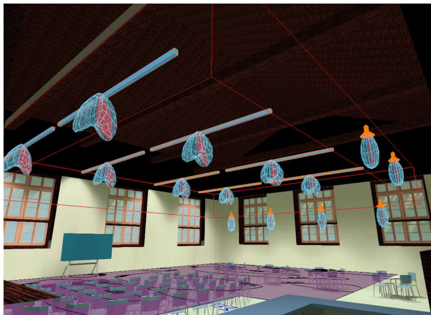
Εικόνα 88: Φωτιστικά σώματα χώρου σεμιναρίων, 8 γραμμικά φωτιστικά και 9 καμπάνες.
