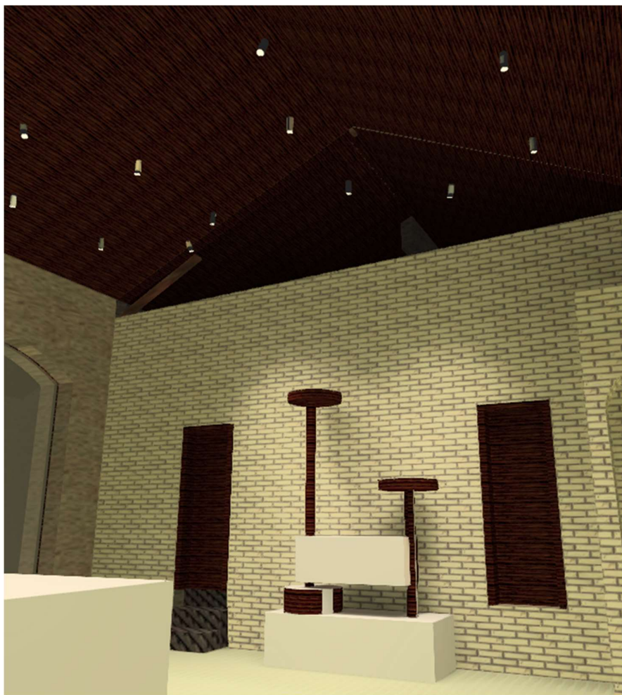
Εικόνα 98: Προσομοίωση φωτισμού χώρου Προθαλάμου Μουσείου από το περιβάλλον Dialux.
